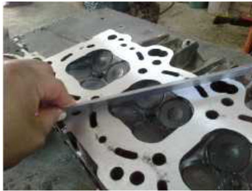
Figura 12. Verificación de la planitud de un cabezote
