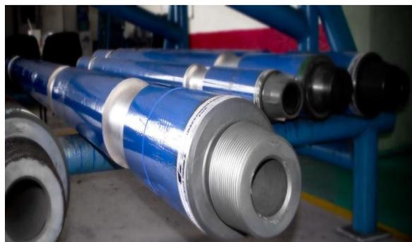
**Fig. 3.8: Martillo Hidraulico.**
