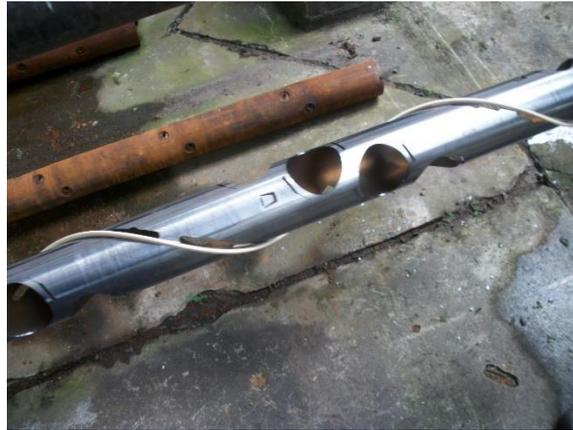
Figura 1.29 Portacargas Rodeado Por Cordón Detonante
