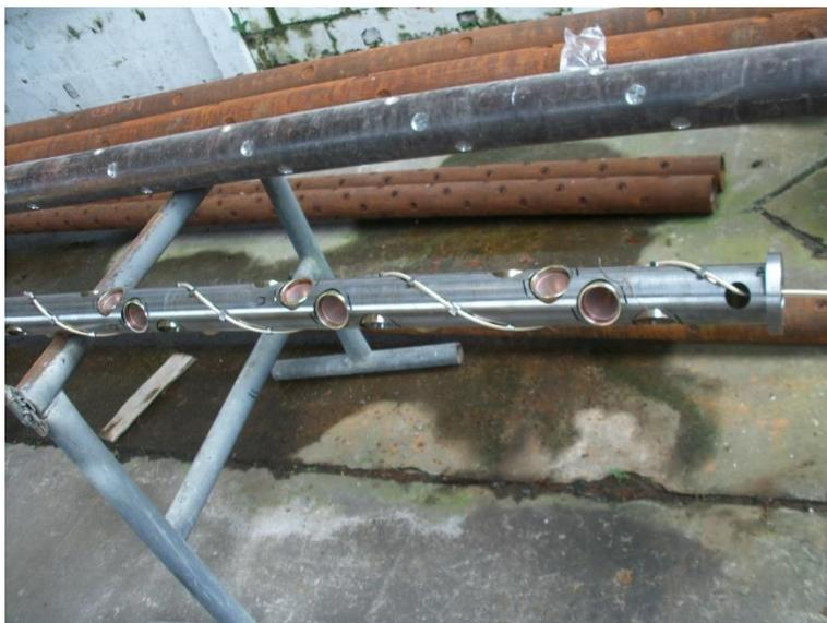
Figura 1.30 Portacargas con Cargas
