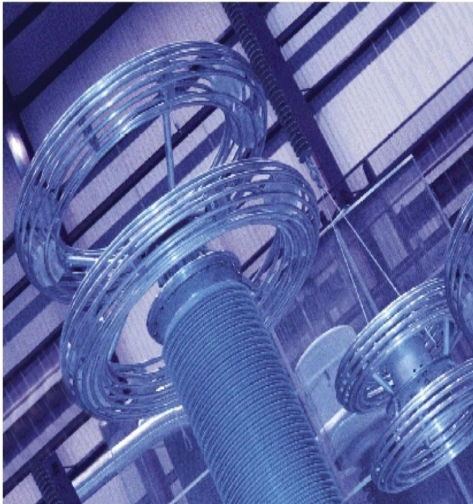
*Prototipo de un transductor óptico de voltaje bajo pruebas en laboratorios de Alto Voltaje*
