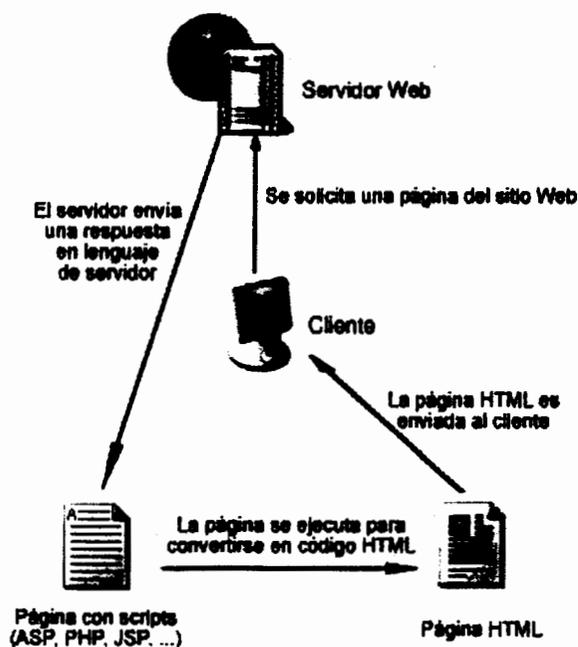
Figura 2.1. Funcionamiento de tecnologías Web del lado servidor
