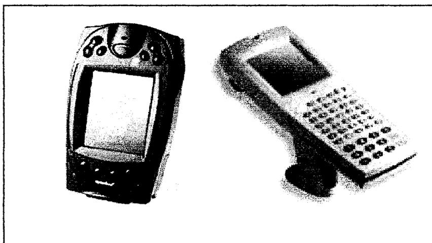
**Figura 2.12** Colectores de datos que se utilizan en redes inalámbricas SS.
