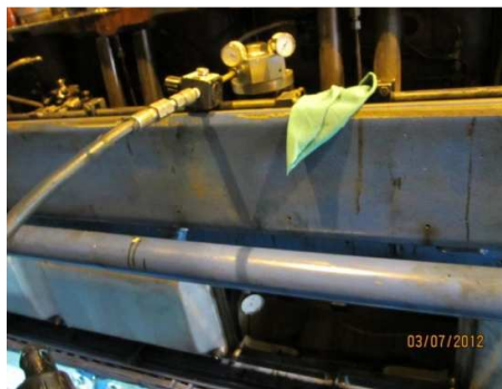
FIGURA 3.8 MEDICIÓN DEL TIEMPO DE INYECCIÓN.
