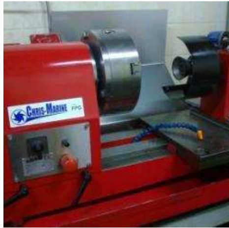
FIGURA 4.3 MÁQUINA LAPEADORA DE INYECTORES.
