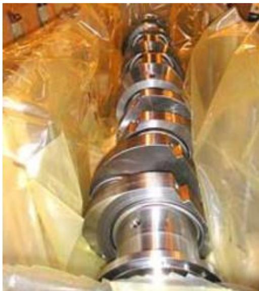
**FIGURA 2. 10 APLICACIÓN DE INHIBIDORES VCI**
