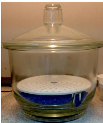
**FIGURA 3.9 DESECADOR PYREX CON GEL DE SÍLICE**
