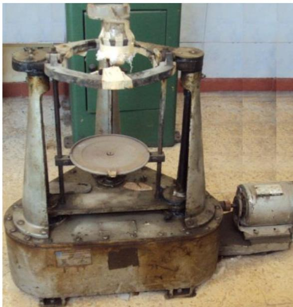
**FIGURA 3.14 TAMIZADOR MECÁNICO**
