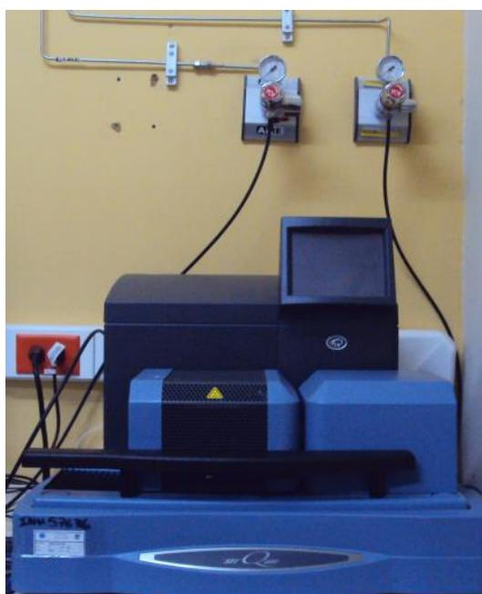
**FIGURA 3.22 ANALIZADOR TÉRMICO SDT Q600**
