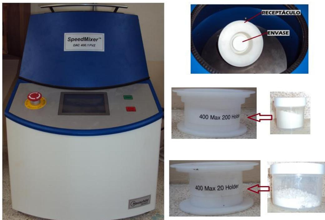
**FIGURA 3.18 MEZCLADOR DE ALTAS REVOLUCIONES SPEEDMIXER
