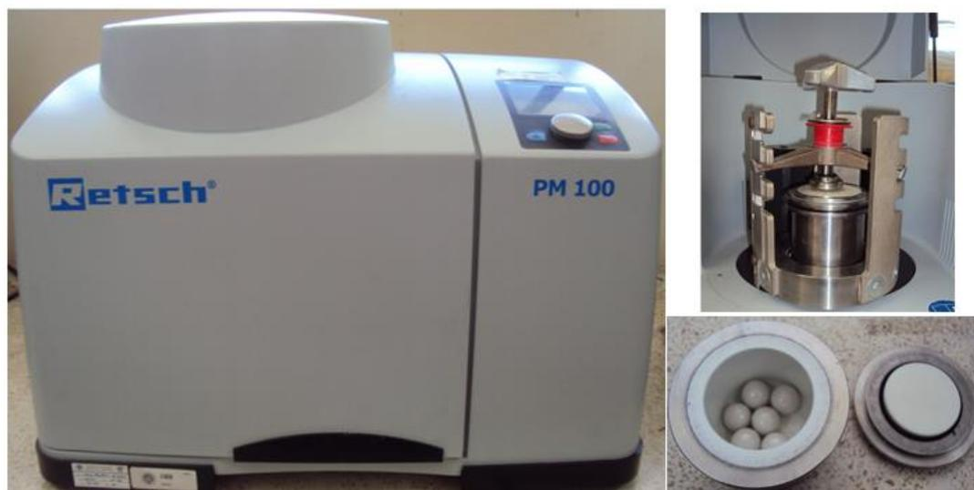
**FIGURA 3.13 MOLINO PLANETARIO DE BOLAS PM 100 Y ACCESORIOS**
