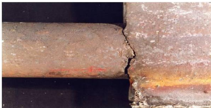
FIGURA 2.13 MECANISMO FALLA FATIGA POR VIBRACIÓN.
