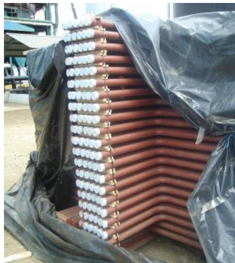
FIGURA 5.3 SECCION DE SOBRECALENTADOR SECUNDARIO.
