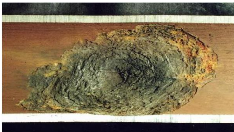
FIGURA 2.6 FALLA POR CORROSIÓN DEL LADO AGUA.
