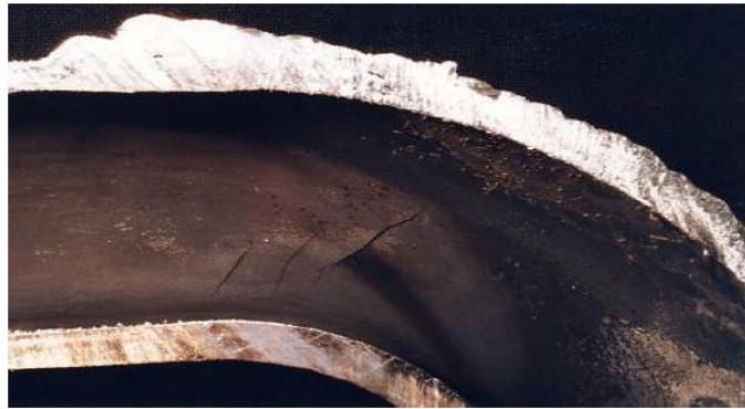
FIGURA 2.10 MECANISMO DE FALLA CORROSIÓN BAJO ESFUERZO.
