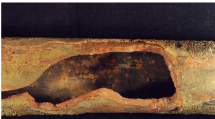
FIGURA 2.8 FALLA ATAQUE POR HIDRÓGENO.
