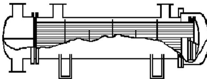
Figura 1. 9 Intercambiador de calor de tubos y coraza [3]
