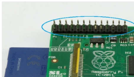
Fig. 2.5 Cabecera P1 conector GPIO [17]
