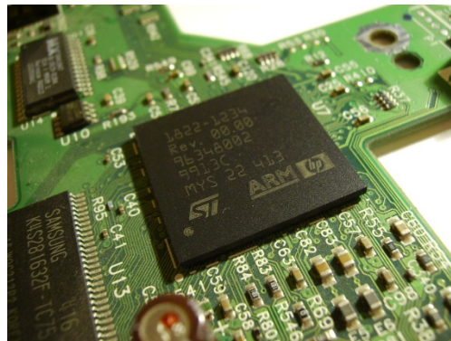
Fig. 2.3 Procesador ARM en una impresora HP [10]
