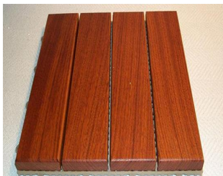
Foto No. 13: Madera Mascarey en decking
