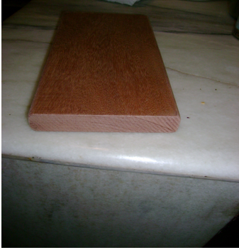
Foto No. 6: Madera Chanul en Decking
