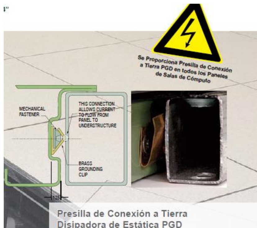
Figura 3.3. Presilla de conexión a tierra
