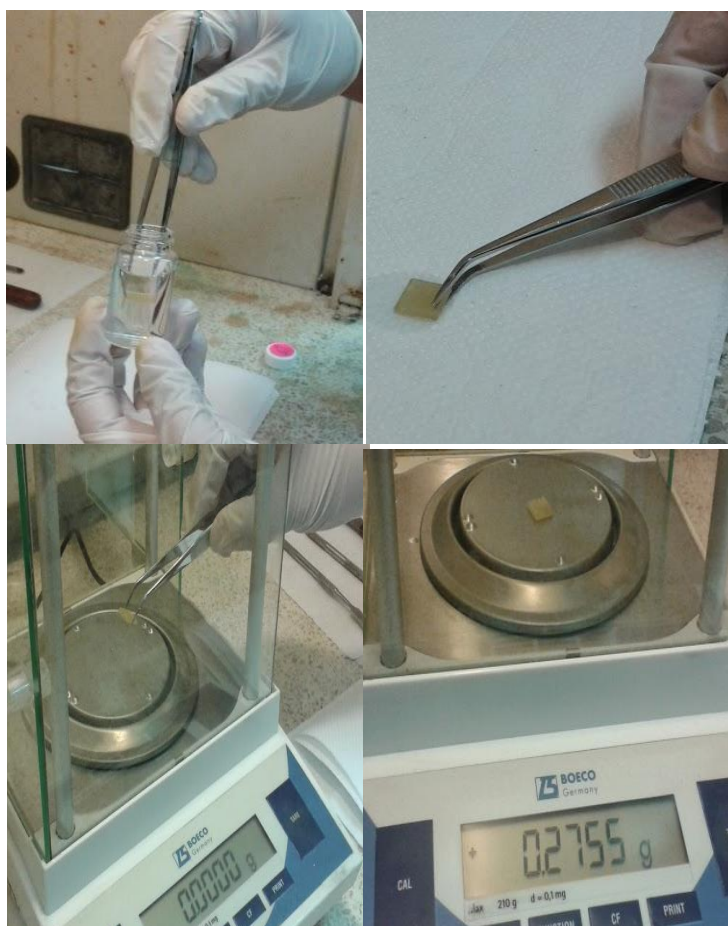
FIGURA 3.21. PROCEDIMIENTO DE MONITOREO PRUEBAS DE HINCHAMIENTO
