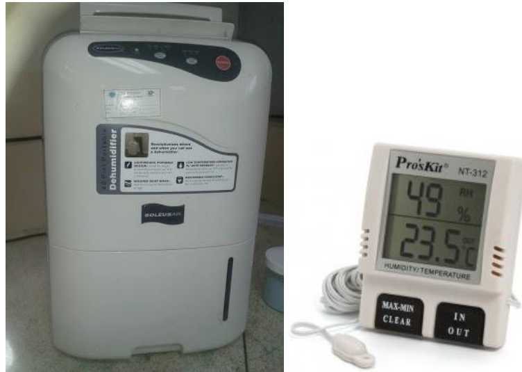
FIGURA 3.3. DESHUMIDIFICADOR Y MEDIDOR DE TEMPERATURA-HUMEDAD
