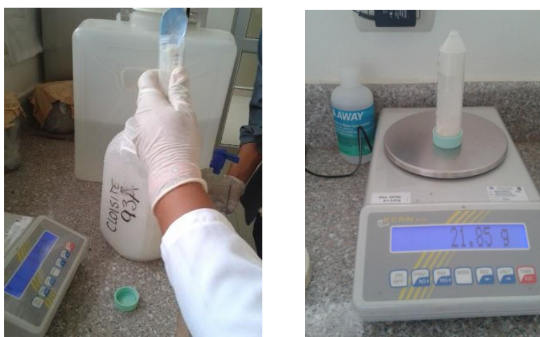
FIGURA 3.13. LLENADO DE ARCILLAS CON AGUA DESIONIZADA
