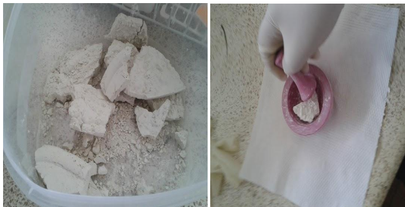
FIGURA 3.15. ARCILLA MOLIDA CON MORTERO
