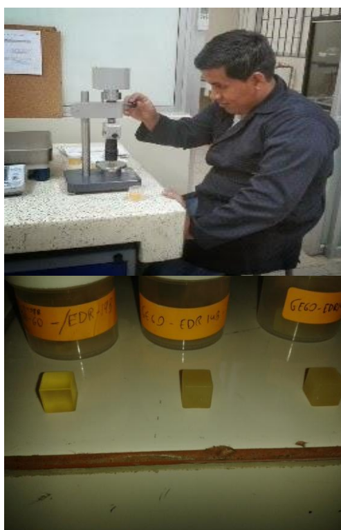
FIGURA 3.23. MEDICIÓN DE DUREZA Y PROBETAS
