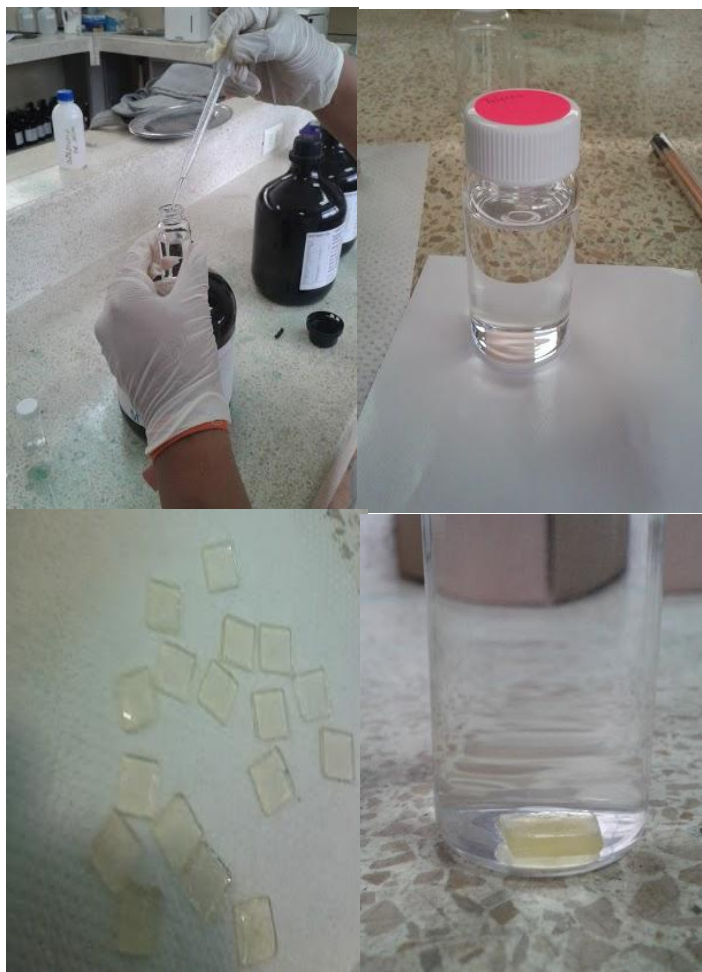
FIGURA 3.20. LLENADO DE RECIPIENTES CON SOLVENTES Y COLOCACIÓN DE PROBETAS EN SU INTERIOR
