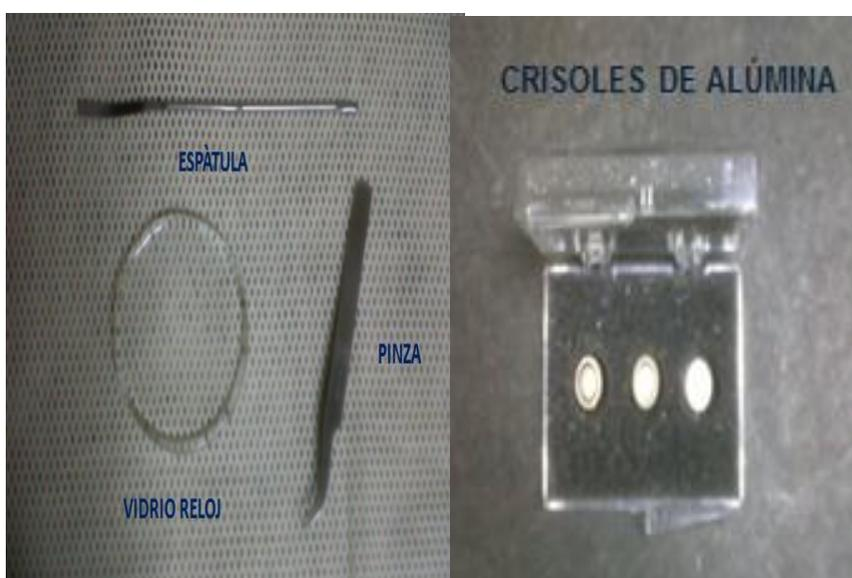
**FIGURA 3.25. UTENSILIOS PARA ENSAYOS DE TGA**
