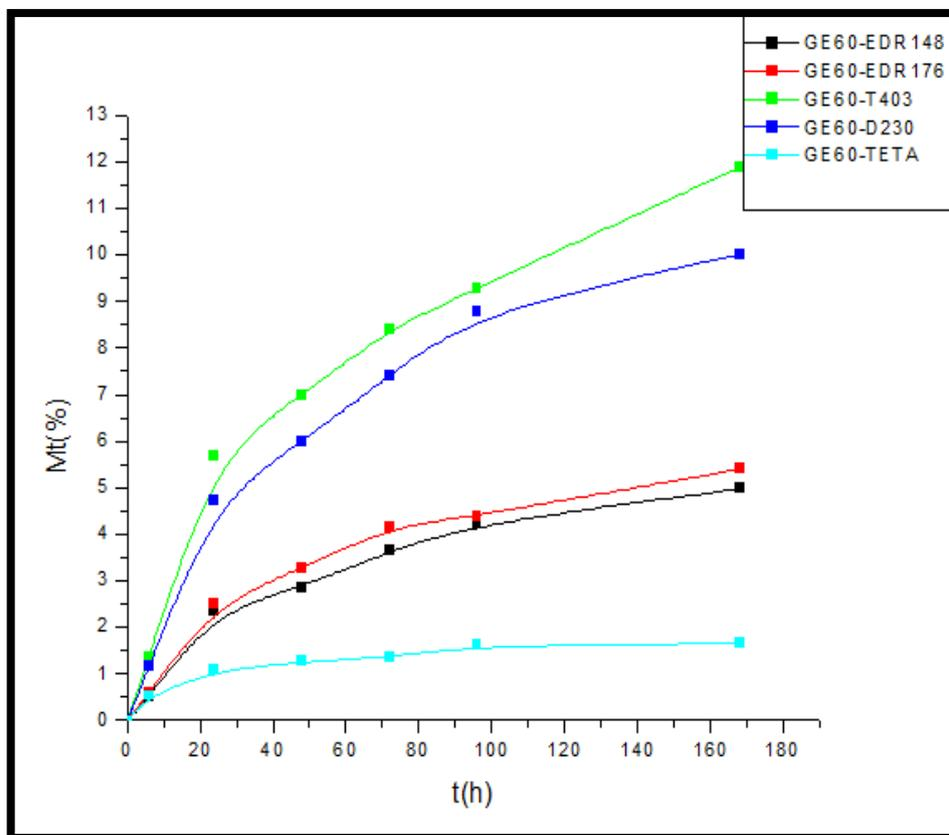
**FIGURA 4.3. CURVA DE Mt (%) VS t (h) DE RESINA AMINA SUMERGIDO EN ETANOL**
