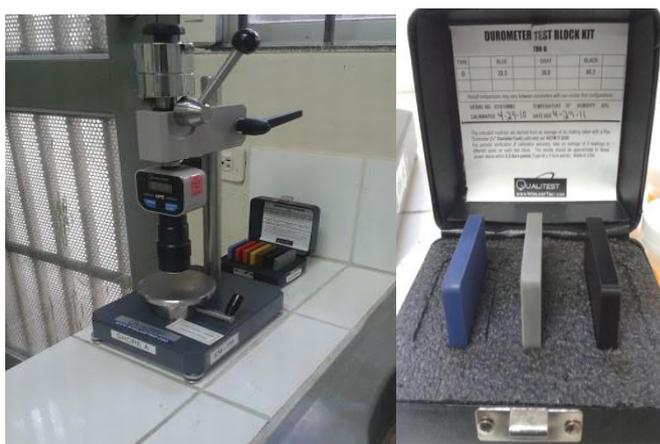
**FIGURA 3.22. DURÓMETRO Y CAJA MATERIALES DE REFERENCIA**
