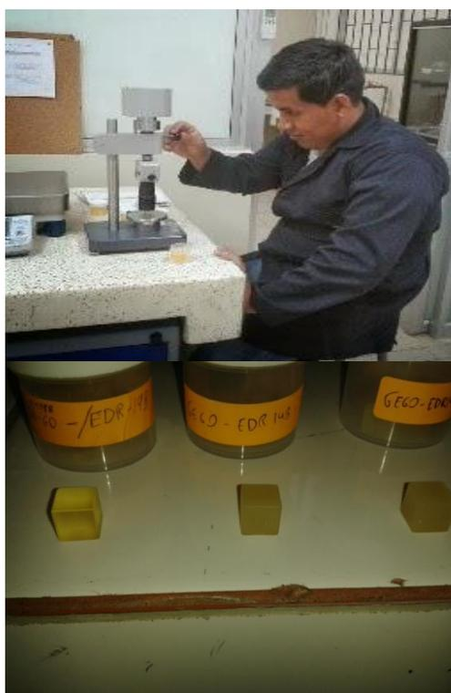
**FIGURA 3.23. MEDICIÓN DE DUREZA Y PROBETAS**
