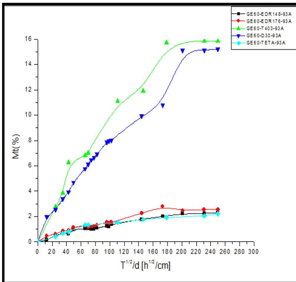
**FIGURA 4.10. CURVA DE DIFUSIÓN RESINA-AMINA-ARCILLA
