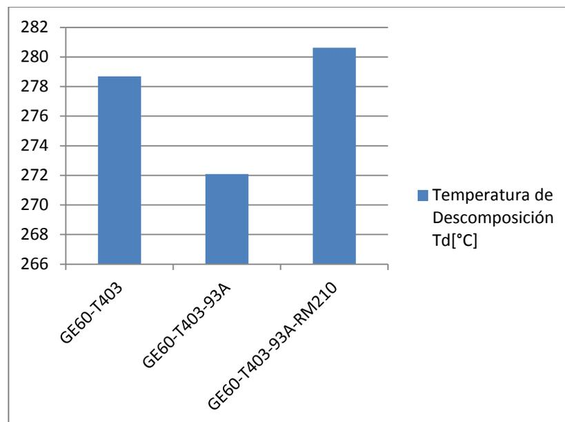
**FIGURA 4.26. GRÁFICO TEMPERATURA DE DESCOMPOSICIÓN CURADO CON T403**
