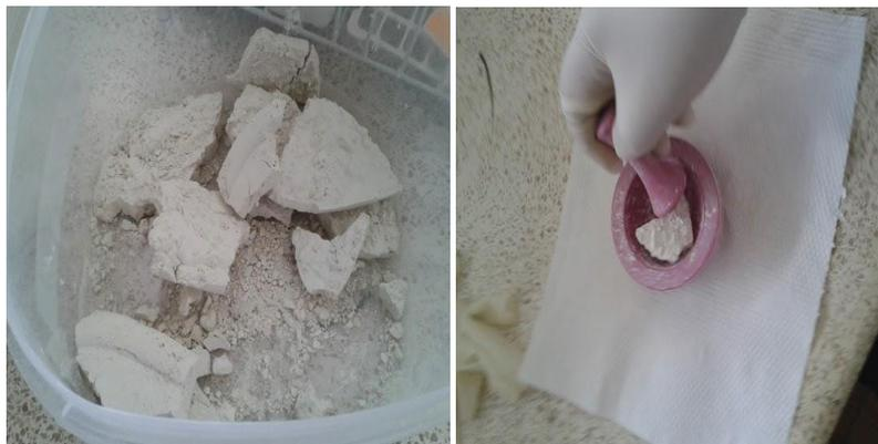
**FIGURA 3.15. ARCILLA MOLIDA CON MORTERO**
