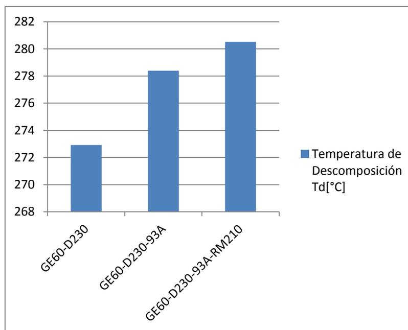
FIGURA 4.22. GRÁFICO TEMPERATURA DE DESCOMPOSICIÓN
