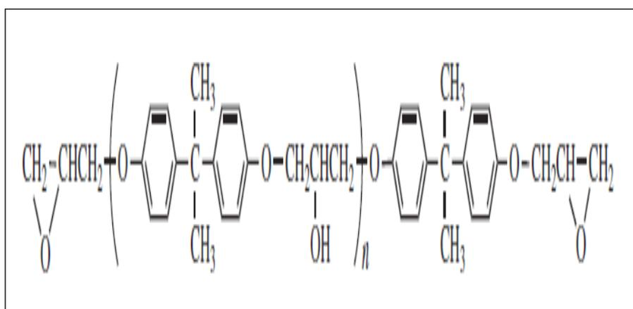
**FIGURA 2.3. ESTRUCTURA MOLECULAR DE RESINA A
