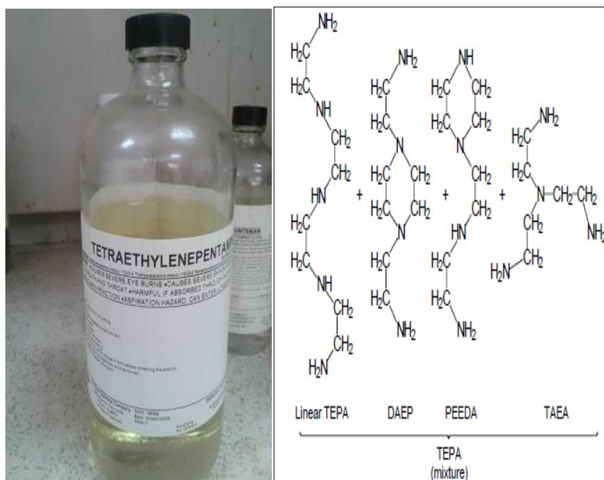
**FIGURA 2.11. AMINA LÍQUIDA TETRAETILENPENTAMINA Y ESTRUCTURA MOLECULAR**
