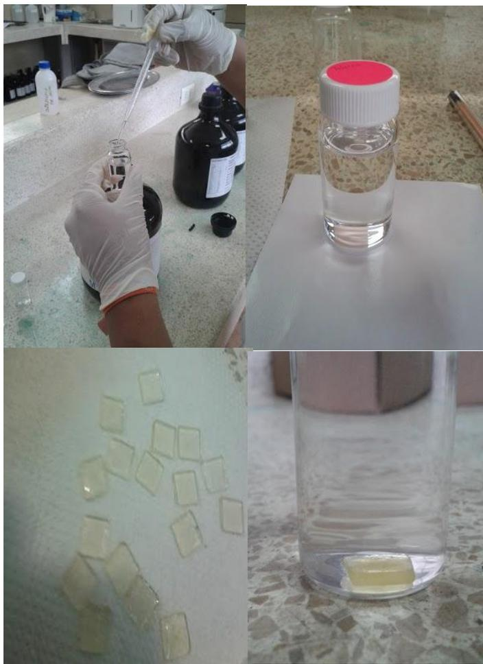
**FIGURA 3.20. LLENADO DE RECIPIENTES CON SOLVENTES Y COLOCACIÓN DE PROBETAS EN SU INTERIOR**
