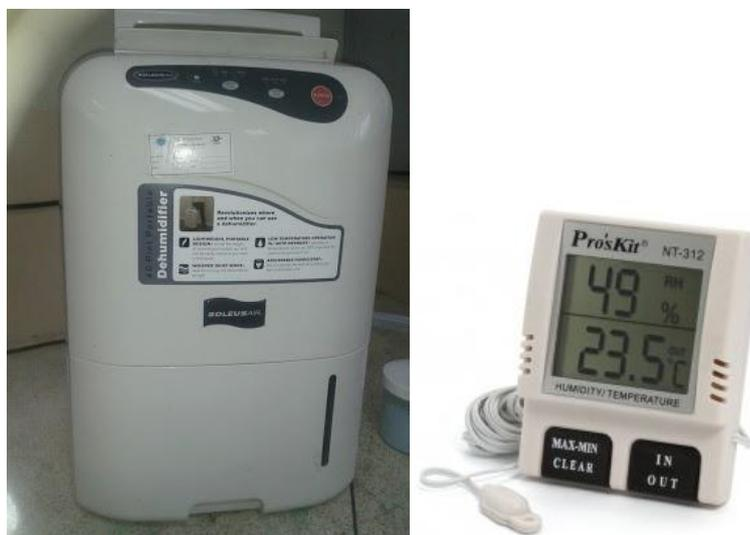
**FIGURA 3.3. DESHUMIDIFICADOR Y MEDIDOR DE TEMPERATURA-HUMEDAD**
