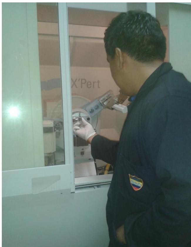
**FIGURA 3.27. DIFRACTÓMETRO DE RAYOS X**
