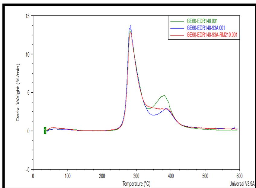
**FIGURA 4.17. SUPERPOSICIÓN DE TERMOGRAMAS DERIVADA
