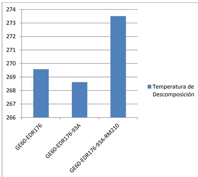
**FIGURA 4.18. GRÁFICO TEMPERATURA DE DESCOMPOSICIÓN CURADO DON EDR176**
