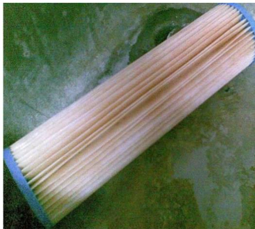
**FIGURA 3.39. FILTRO PARA PARTÍCULAS USADO EN EL PROYECTO**
