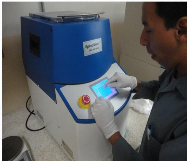
**FIGURA 3.56. MEZCLADO AUTOMÁTICO SPEED MIXER
