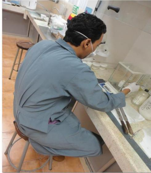
**FIGURA 3.59. PROCESO DE ADHESIÓN DE RESINA A LA MEZCLA RESINA - ARCILLA-INHIBIDOR – MEZCLA 2 OPTIMIZADA FINAL**
