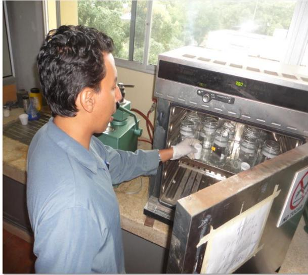
**FIGURA 3.57. SEGUNDA PUESTA AL HORNO DE LA MEZCLA RESINA -ARCILLA - INHIBIDOR – MEZCLA 2 OPTIMIZADA FINAL**
