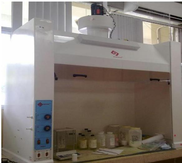
**FIGURA 3.42. SORBONA USADA EN EL PROYECTO**
