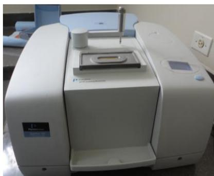
**FIGURA 3.24. ESPECTROFOTÓMETRO (FTIR) USADO EN EL PROYECTO**
