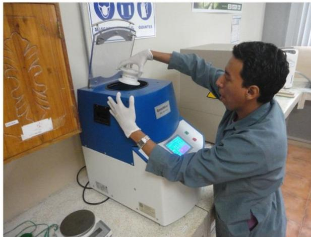
**FIGURA 3.58. SEGUNDA PUESTA AL SPEED MIXER DE LA MEZCLA RESINA-ARCILLA- INHIBIDOR – MEZCLA 2 OPTIMIZADA FINAL**
