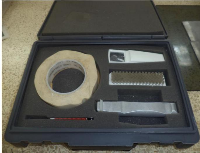
**FIGURA 3.26 EQUIPO DE PRUEBA DE ADHERENCIA**
