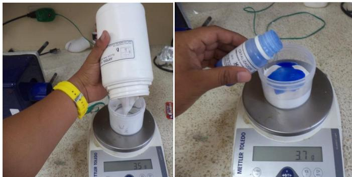
**FIGURA 3.64 PREPARACIÓN DE MEZCLA DE SILICONA Y CATALIZADOR**
