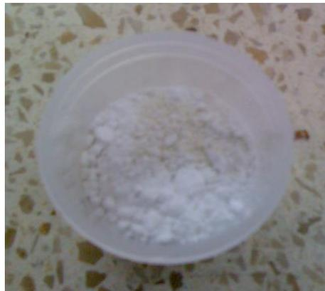
**FIGURA 3.49 ARCILLA E INHIBIDOR JUNTOS**
