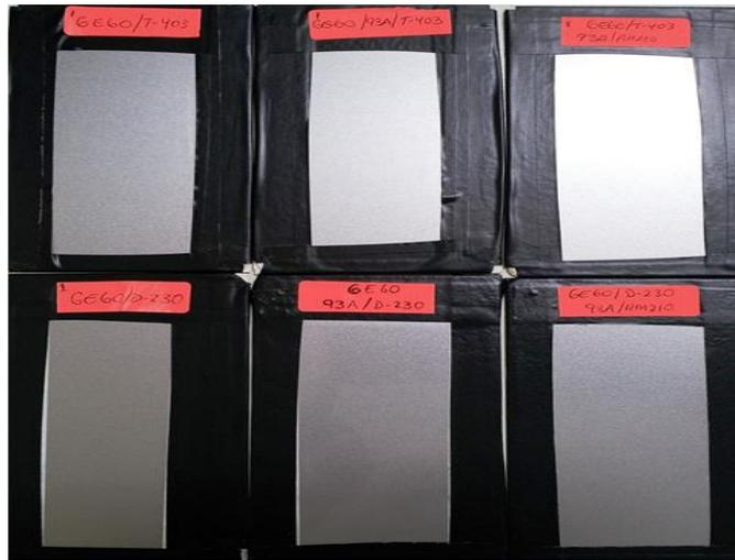
**FIGURA 4.27 PLACAS ESTANDARIZADAS CON RECUBRIMIENTO CONVENCIONAL Y NANOCOMPUESTO A ENSAYARSE**
