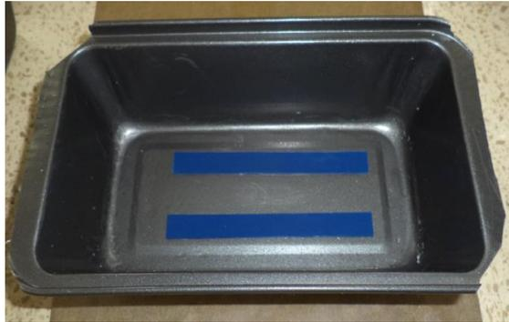
**FIGURA 3.63 MOLDE PARA PROBETAS DE ENSAYO DE TENSIÓN**
