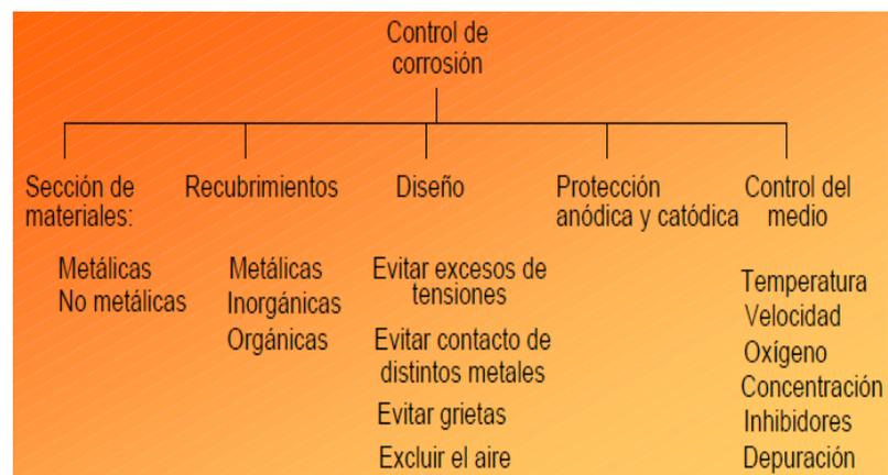
**FIGURA 2.4. MÉTODOS DE CONTROL DE CORROSIÓN. [12]**
