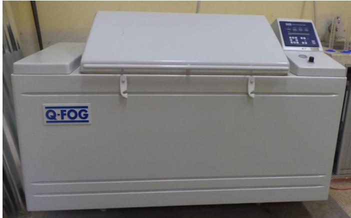
**FIGURA 3.73 EQUIPO DE ENSAYO DE CORROSIÓN**
