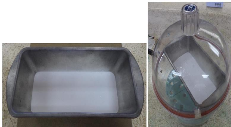
**FIGURA 3.65 LLENADO DEL MOLDE Y ELIMINACIÓN DE BURBUJAS**
