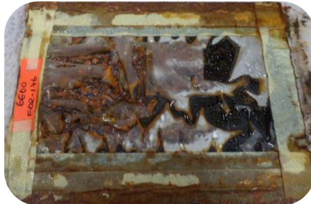
**FIGURA 4.3 ENSAYO DE CORROSIÓN DE GEE60/EDR176**
