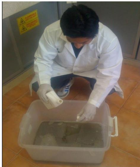
**FIGURA 3.43 PLACAS EN SOLUCIÓN DESOXIDANTE**
