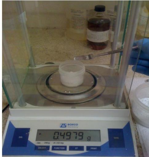
**FIGURA 3.48 MEDICIÓN DEL INHIBIDOR**
