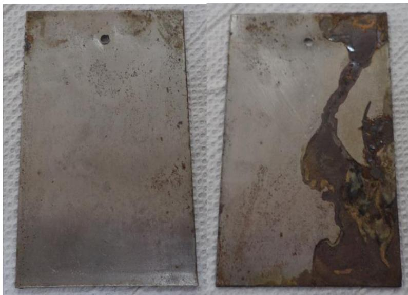
**FIGURA 4.54 PROPAGACIÓN DE CORROSIÓN CON 10% C93A
