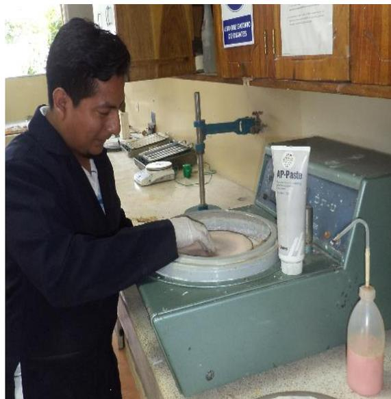
**FIGURA 3.89 PULIDO DE PROBETAS CIRCULARES**
