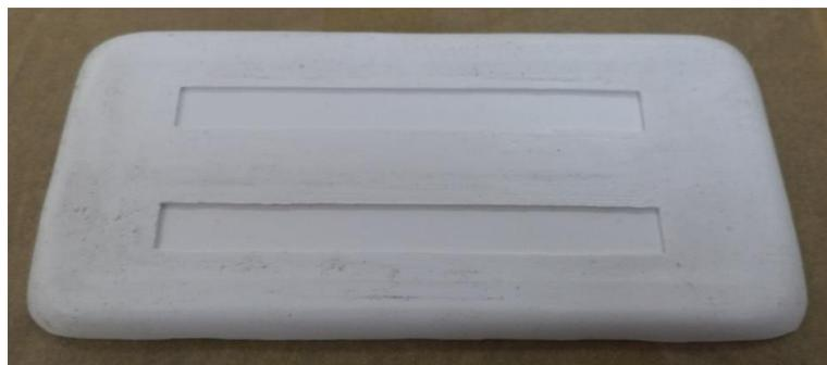
**FIGURA 3.67 MOLDE PARA PROBETAS DE ENSAYO DE TENSIÓN**
