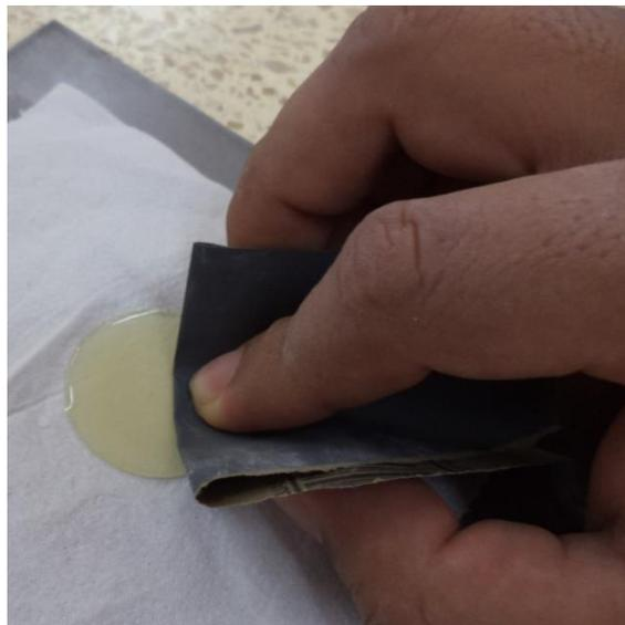
**FIGURA 3.88 LIJADO DE PROBETAS CIRCULARES**
