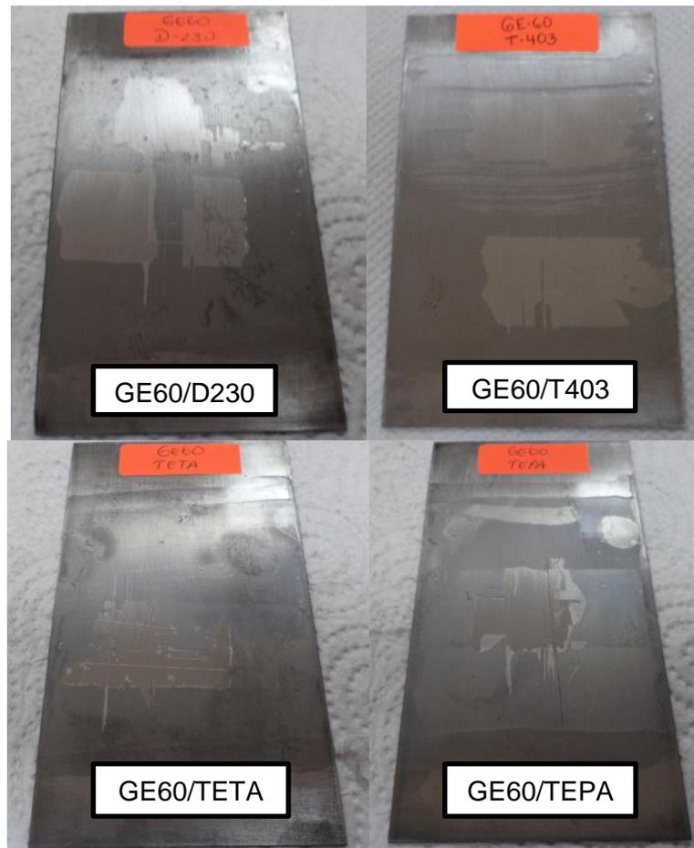
**FIGURA 4.35 ADHERENCIA DE COMPUESTOS
