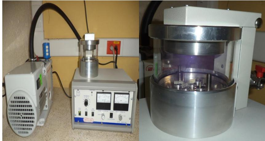
**FIGURA 4.61 EQUIPO DE RECUBRIMIENTO DE PLATINO**
