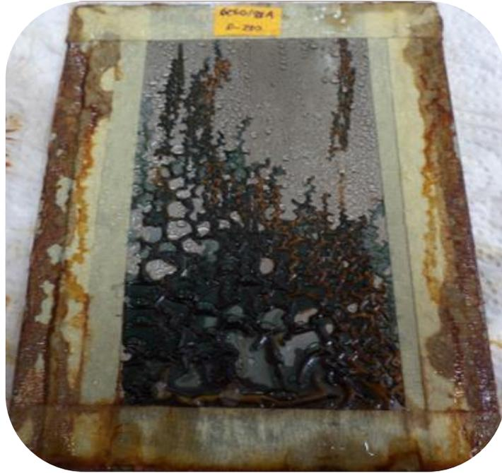
**FIGURA 4.10 ENSAYO DE CORROSIÓN DE GE60/D230/C93A**
