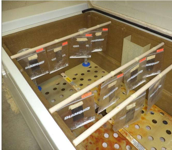
**FIGURA 3.86 COLOCACIÓN DE PROBETAS A ENSAYARSE EN MEDIO CORROSIVO**
