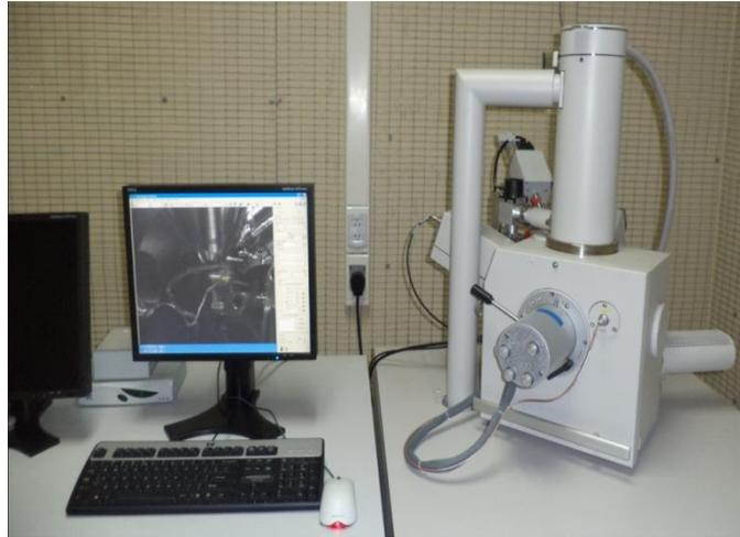
**FIGURA 4.60 MICROSCOPIO ELECTRÓNICO DE BARRIDO**
