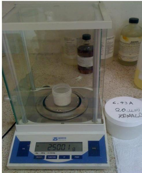
**FIGURA 3.47 MEDICIÓN DE LA ARCILLA**
