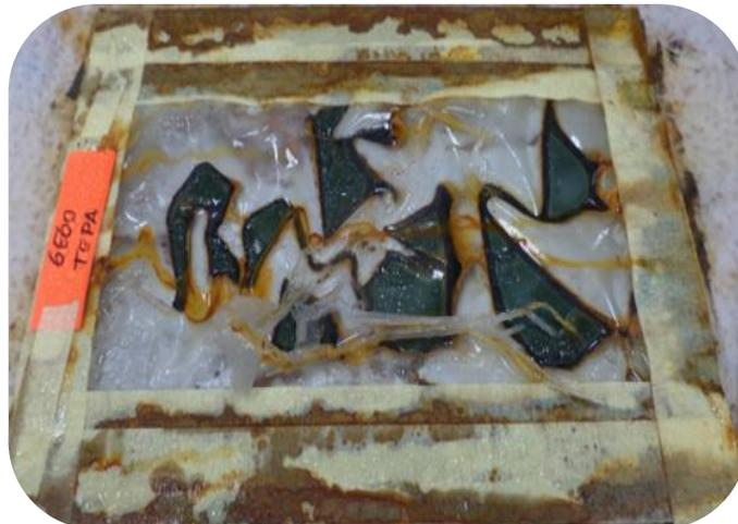
**FIGURA 4.7 ENSAYO DE CORROSIÓN DE GE60/TEPA**
