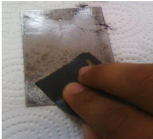
**FIGURA 3.82 LIJADO DE PLACAS RECTANGULARES**
