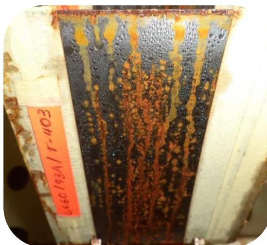
FIGURA 4.11 ENSAYO DE CORROSIÓN DE GE60/T403/C93A
