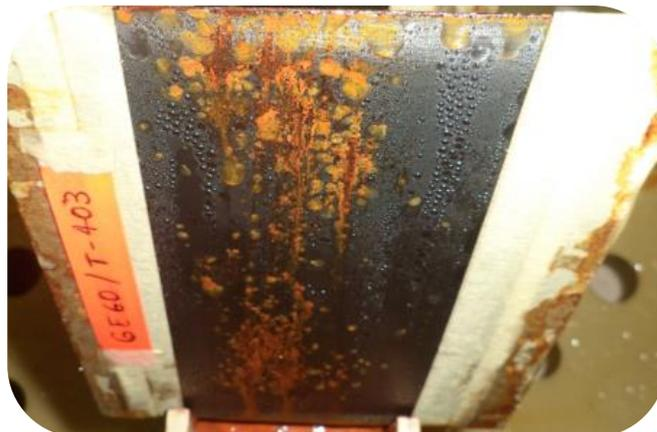
**FIGURA 4.5 ENSAYO DE CORROSIÓN DE GE60/T403**
