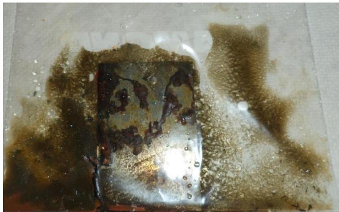
**FIGURA 4.57 INMERSIÓN DE AGUA SALINA DENTRO DE LA FUNDA PLÁSTICA**
