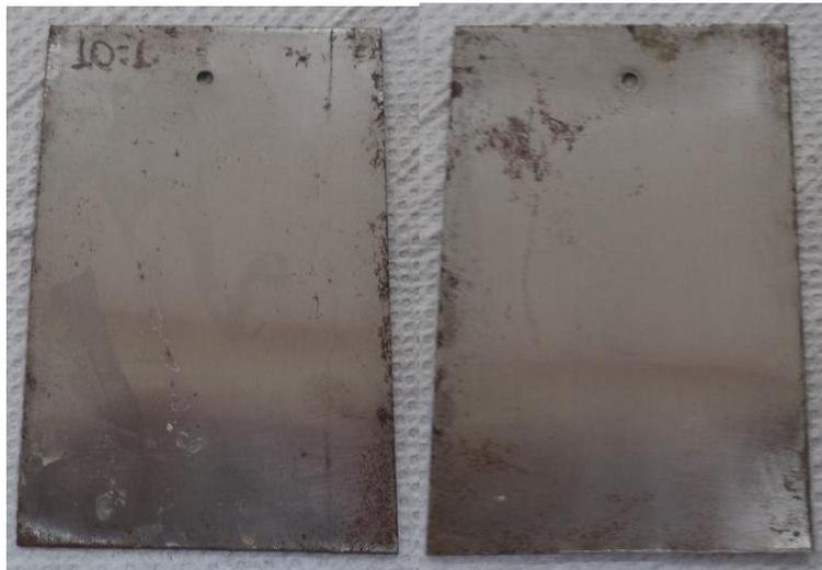
**FIGURA 4.53 PROPAGACIÓN DE CORROSIÓN CON 10% C93A DE 0,5 GR RM210 CONTROL 1**
