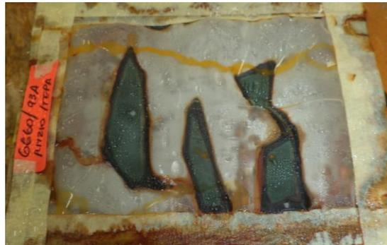
**FIGURA 4.24 NANOCOMPUESTO CON ARICILLA E INHIBIDOR
