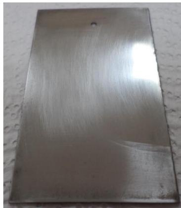
**FIGURA 3.14 PLACA DE ACERO DE BAJO CARBONO**
