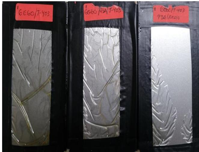
**FIGURA 4.33 RESISTENCIA A LA CORROSIÓN A LAS 8 HORAS**
