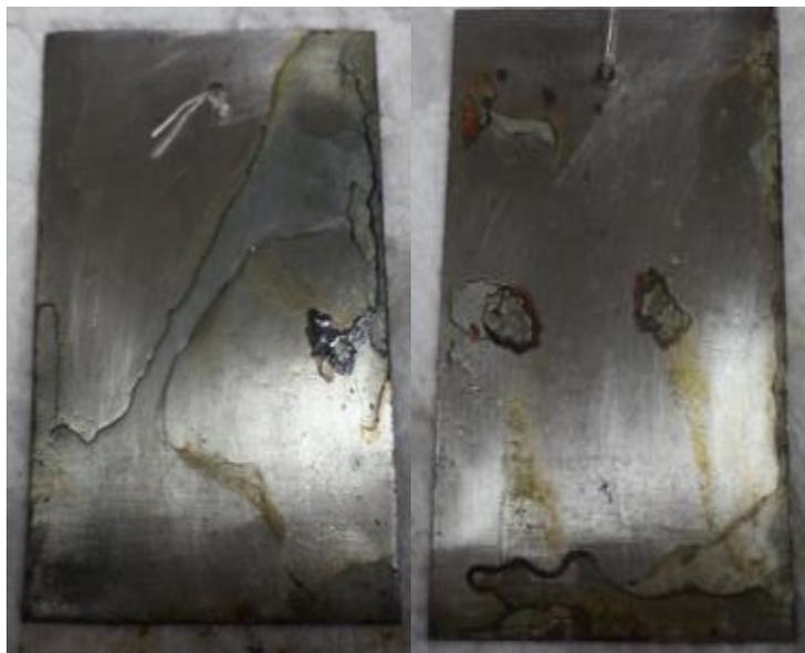
**FIGURA 4.47 PROPAGACIÓN DE CORROSIÓN EN PLACA DE CONTROL 1**
