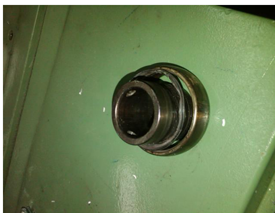
FIGURA 3.5 DAÑO DE RODAMIENTO POR FALTA DE LUBRICACIÓN
