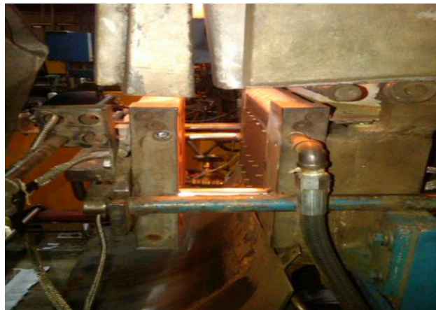
FIGURA 3.7 MOLDE CON DUCTOS TAPONADOS
