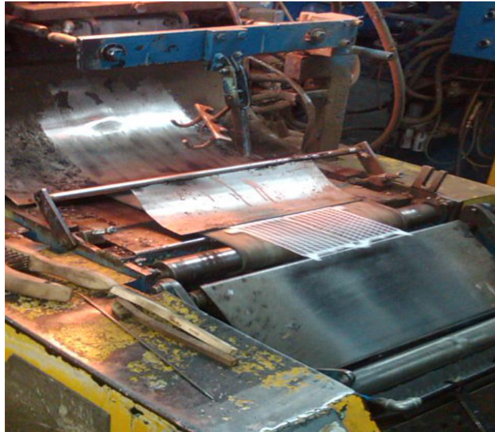
FIGURA 3.25 BANDA TRANSPORTADORA DE REJILLAS
