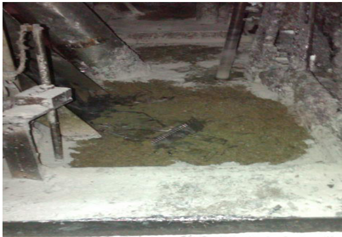
FIGURA 3.2 CRISOL CON EXCESO DE ESCORIA
