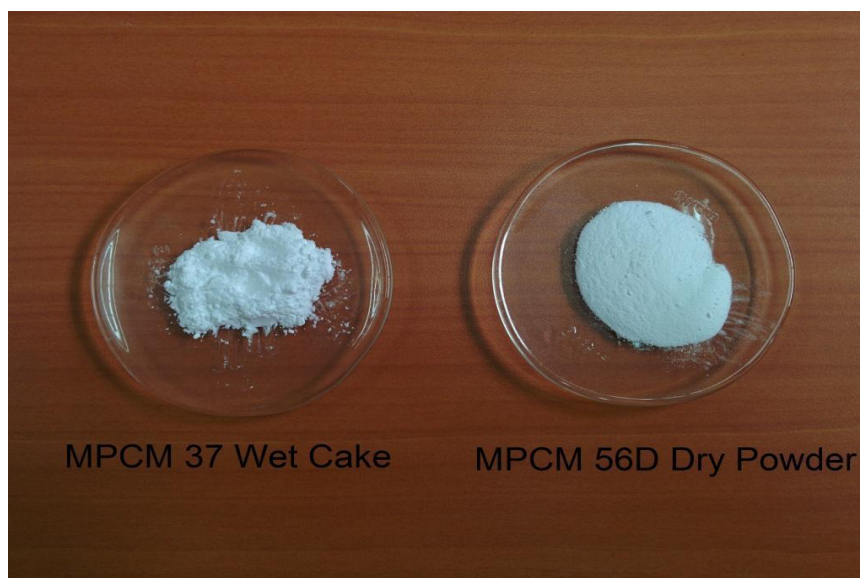
FIGURA 2.7 PRESENTACIÓN DE MATERIALES MPCM
