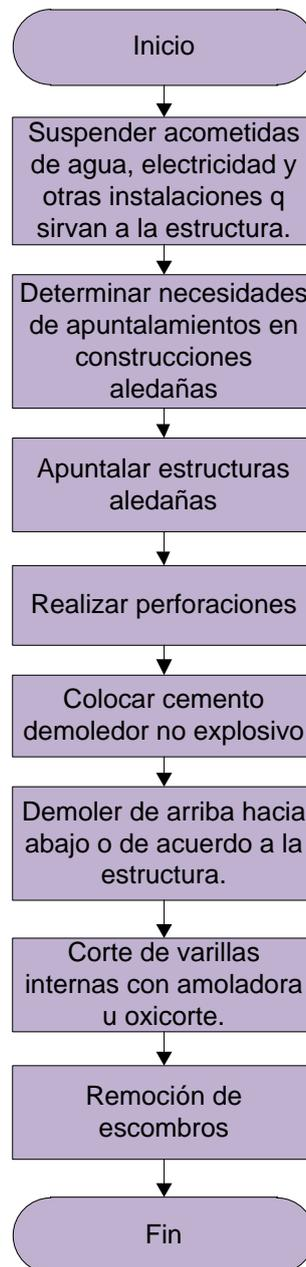
**FIGURA 4.5 DIAGRAMA DE FLUJO DE LA TAREA DEMOLICIÓN**
