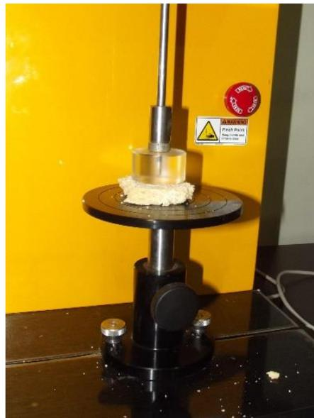
La determinación de la dureza se hizo mediante la compresión de la miga con el texturómetro con una velocidad de 1 mm/s.
