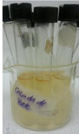
**FIGURA 2.6 TUBOS DE AGUA DE TRIPTONA CON INDOL POSITIVO PARA LA MUESTRA DE COLADA**
