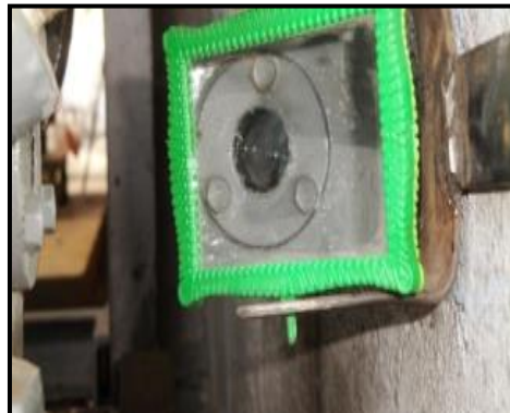
FIGURA 7.29 TRATAMIENTO DE LDA VISOR DE ACEITE
