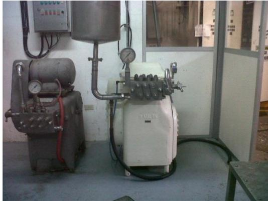
**FIGURA 3.9. HOMOGENIZADOR**
