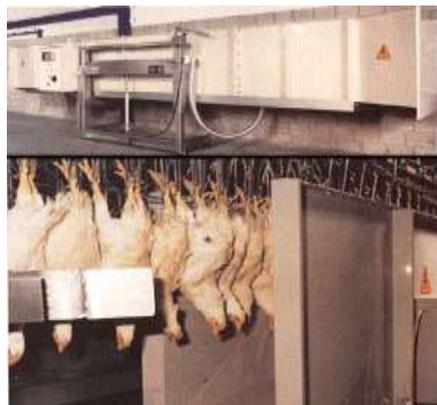
Figura 3.6.3.c Aturdidor de Alta Frecuencia
