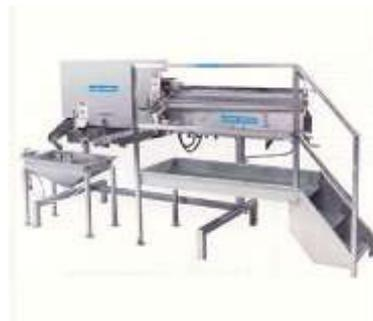
Figura 3.6.3.k Máquina Recolectora de Hígado y Corazón
