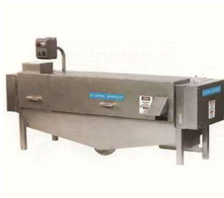
Figura 3.6.3.I Máquina Recolectora de Mollejas
