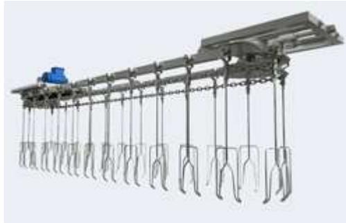
Figura 3.6.3.b Transportador Aéreo
