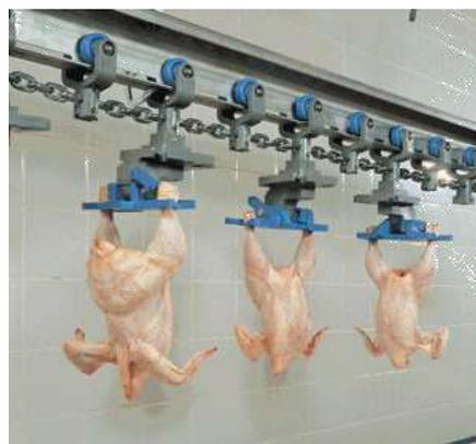
Figura 3.6.3.ñ Sistema de Corte Inteligente
