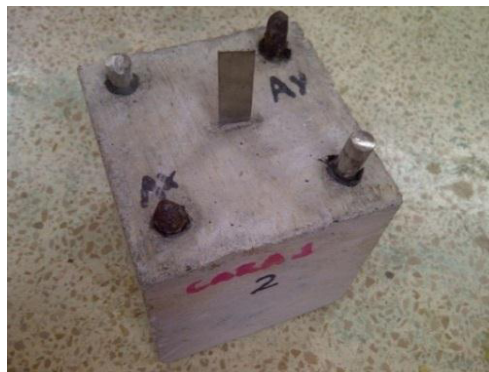
FIGURA 2.7: PROBETA CÚBICA DE HORMIGÓN ARMADO TERMINADA.
