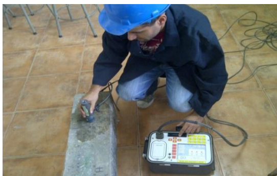
FIGURA 2.28: CIRCUITO CERRADO USANDO EL “SENSOR B” PARA MEDIR POTENCIAL DE CORROSIÓN Y RESISTIVIDAD.
