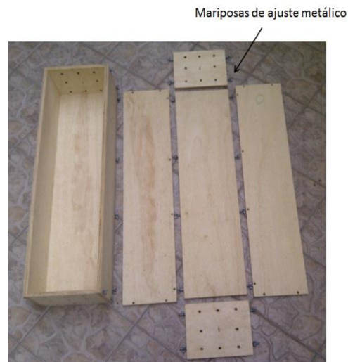
FIGURA 2.9: MOLDES DE MADERA ARMADO Y DESARMADO.
