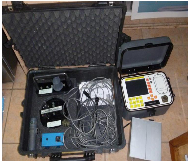
FIGURA 1. EQUIPO DE CAMPO GECOR8, USADO PARA MEDIR LA VELOCIDAD DE CORROSIÓN, POTENCIAL DE CORROSIÓN Y RESISTIVIDAD DEL HORMIGÓN.
