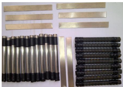
FIGURA 2.2: BARRAS DE ACERO AISI 304 (INFERIOR IZQUIERDA), ASTM A-42 (INFERIOR DERECHA) Y ERI (TITANIO) (PARTE SUPERIOR).
