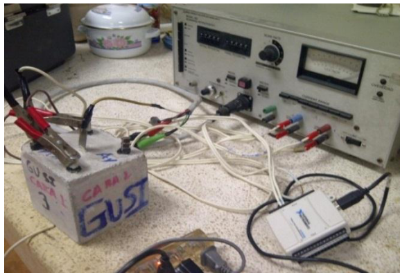
FIGURA 2.26: CONEXIÓN DEL POTENCIO-GALVANOSTATO.
