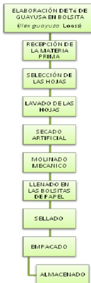
**FIGURA 2.5 DIAGRAMA DE FLUJO GENERAL DE LA ELABORACIÓN DEL TÉ DE GUAYUSA EN BOLSITAS**
