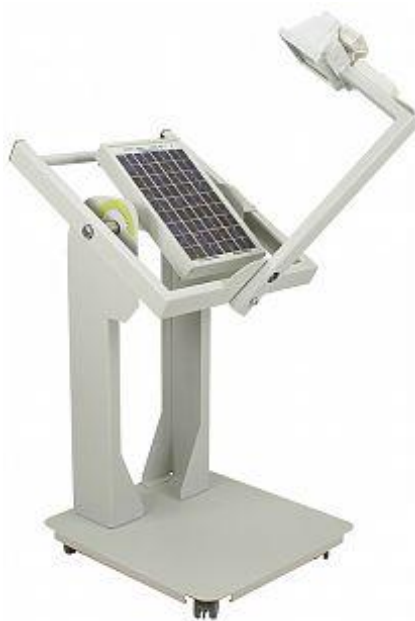
Figura 2.23 Módulo solar con emulador de la altura del sol (CO3208-1B). [1]
