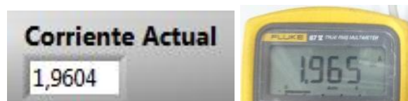
Figura 3.39 Corriente del panel solar obtenidos por la CompactDAQ y por el multímetro Fluke87V.
