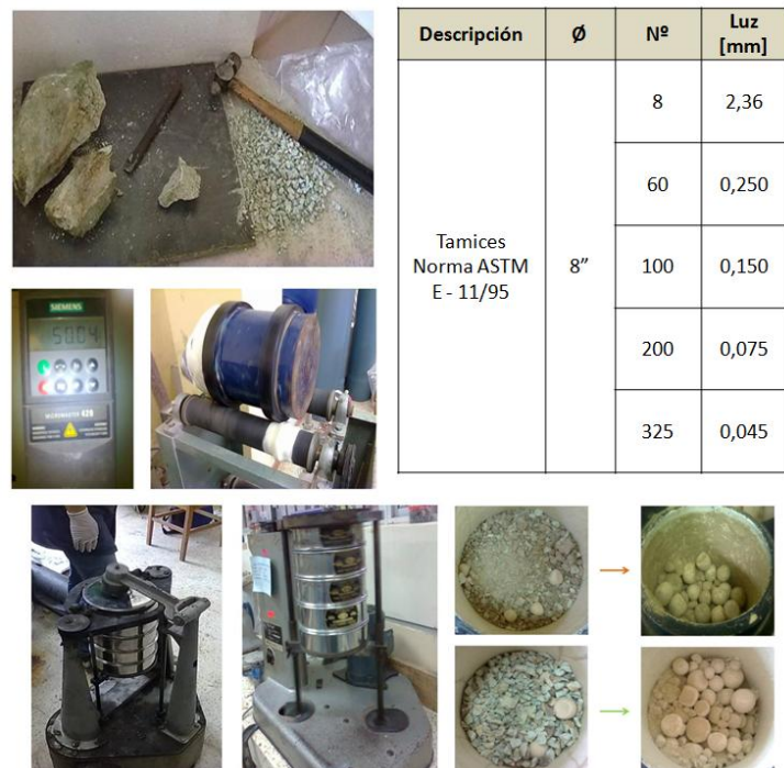
Figure 3.3. Procedimiento para obtención de zeolita con tamaño de grano de 45 \mu\text{m} .
