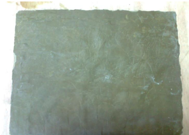
Figura 4.8. Techo S2' con 40% KOH - 12M.
