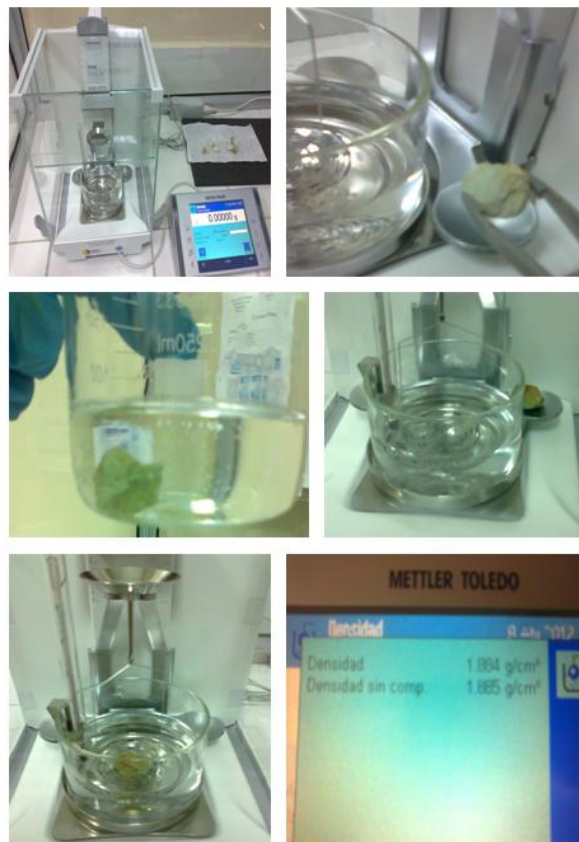
Figura 3.9. Pasos para la medición de la densidad.
