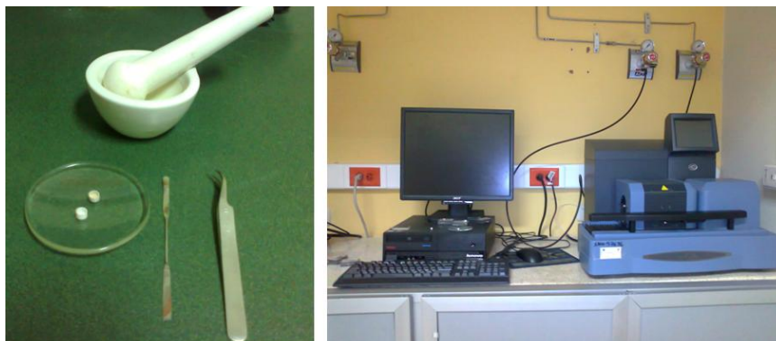
Figura 3.11. Equipos y utensilios para ensayo TGA-DSC.
