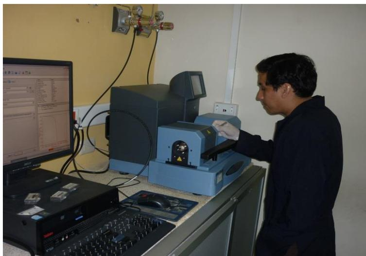
**FIGURA 2.48. ANÁLISIS DE ESTABILIDAD TÉRMICA**
