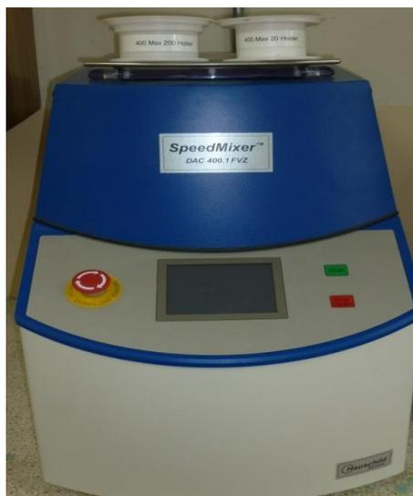
**FIGURA 2.17. SPEEDMIXER Y HOLDER PARA COLOCAR MUESTRA**
