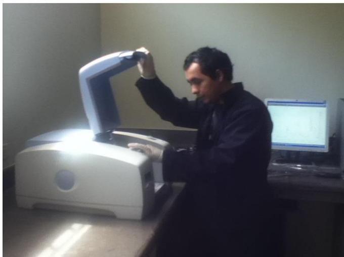
**FIGURA 2.47. ENSAYO DE ESPECTROMETRÍA INFRARROJA**
