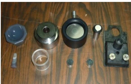
**FIGURA 2.27. INSTRUMENTOS PARA OBTENER PASTILLAS PARA FTIR**
