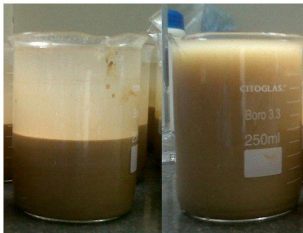
**FIGURA 2.34. DECANTAMIENTO Y NO DECANTAMIENTO CON FACILIDAD DE LAS MUESTRAS**
