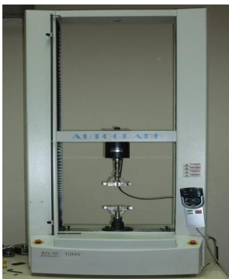
**FIGURA 2.29. MÁQUINA DE ENSAYOS UNIVERSALES**
