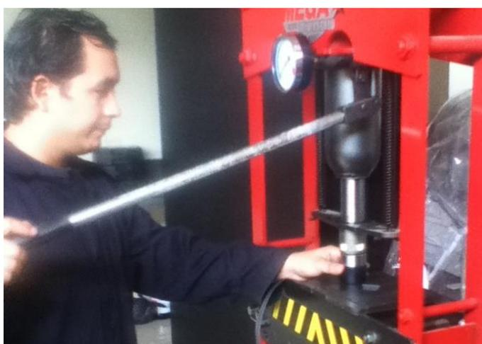
**FIGURA 2.46. CONFORMADO DE PASTILLAS PARA FTIR**
