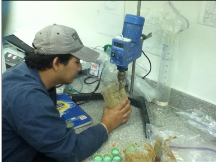
**FIGURA 2.40. AGITACIÓN MECÁNICA PARA LOGRAR INTERCAMBIO CATIÓNICO**
