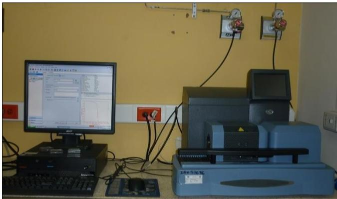
**FIGURA 2.28. ANALIZADOR TERMOGRAVIMÉTRICO**
