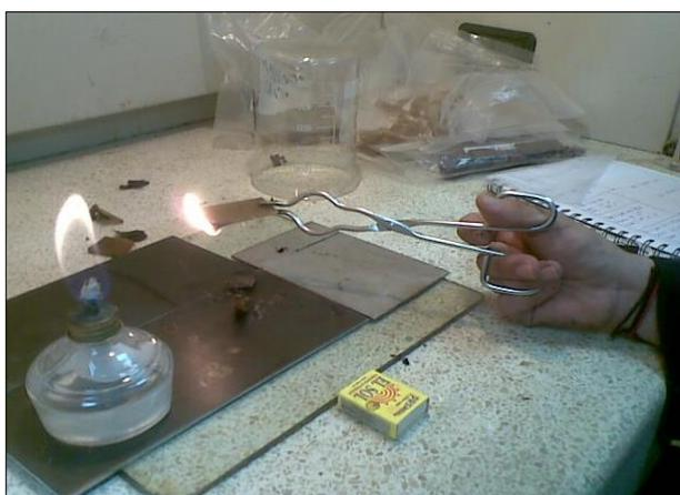
**FIGURA 2.53. ENSAYO DE FLAMABILIDAD**
