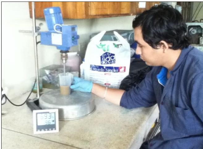
**FIGURA 2.37. AGITACIÓN MECÁNICA DE LA MEZCLA POR 30 MINUTOS**
