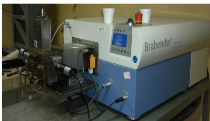
**FIGURA 2.9. REÓMETRO DE TORSIÓN MARCA BRABENDER**
