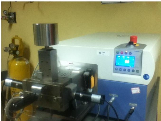
**FIGURA 2.45. OBTENCIÓN DE NANOCOMPUESTOS EN EL REÓMETRO**
