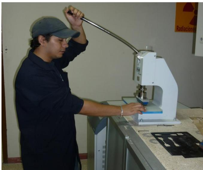
**FIGURA 2.49. CORTE DE PLACAS EN EL TROQUEL**
