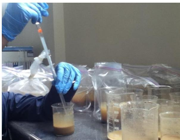
**FIGURA 2.35. ELIMINACIÓN DE LÍQUIDO SOBRENADANTE**
