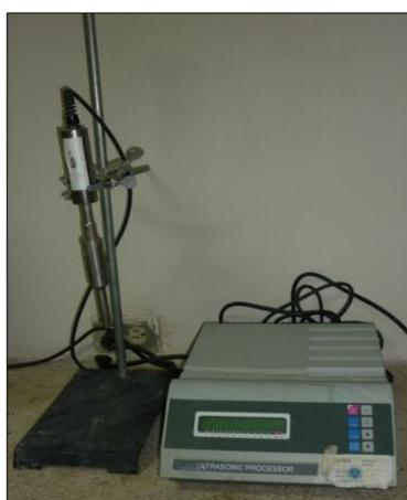
**FIGURA 2.13. AGITADOR ULTRASÓNICO**
