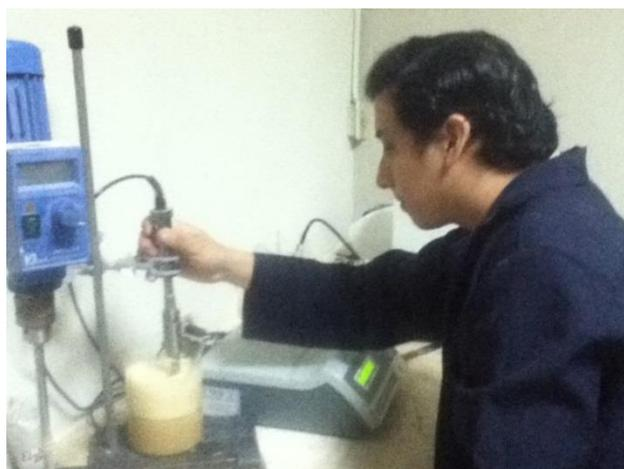
**FIGURA 2.43. AGITACIÓN ULTRASÓNICA DE LA MUESTRA**
