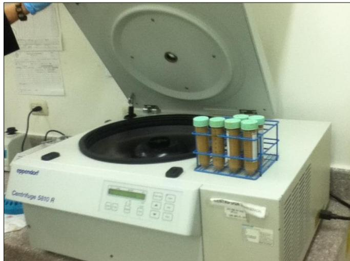
**FIGURA 2.41. MUESTRAS A CENTRIFUGARSE DURANTE EL INTERCAMBIO CATIÓNICO**
