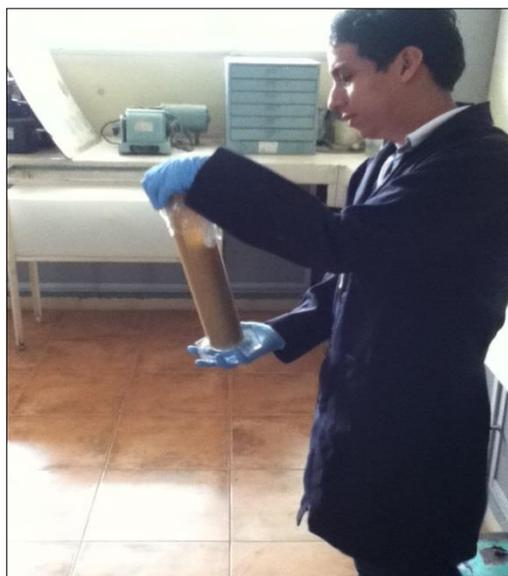
**FIGURA 2.38. AGITACIÓN EN PROBETA DURANTE 20 SEGUNDOS**
