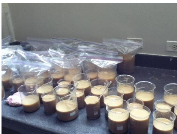
**FIGURA 2.32. MUESTRAS PARA ELIMINACIÓN DE ELEMENTOS ORGÁNICOS Y CARBONATOS**
