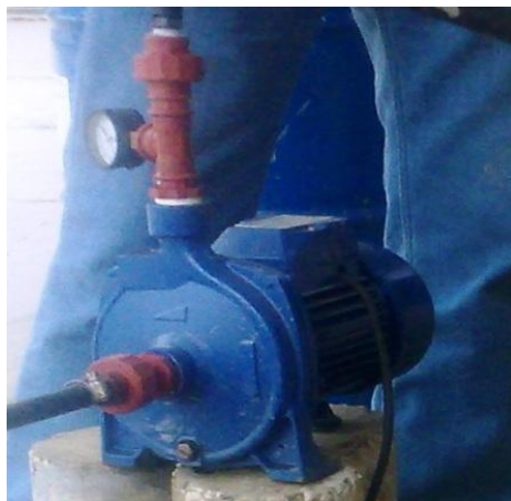
FIGURA 3.8 BOMBA INSTALADA CON MANGUERAS Y MANÓMETROS.
