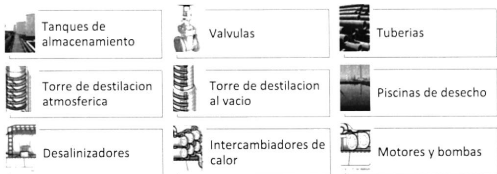
Figura 3.1: Componentes básicos de una refinación
