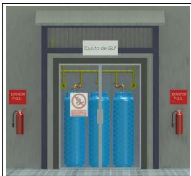
**Figura 5.11.** Cuarto de hormigón para tanques de GLP
