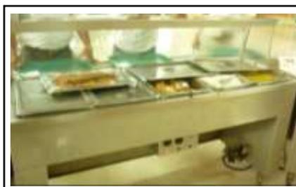
**Figura 4.18.** Autoservicio en Caliente Eléctrico
