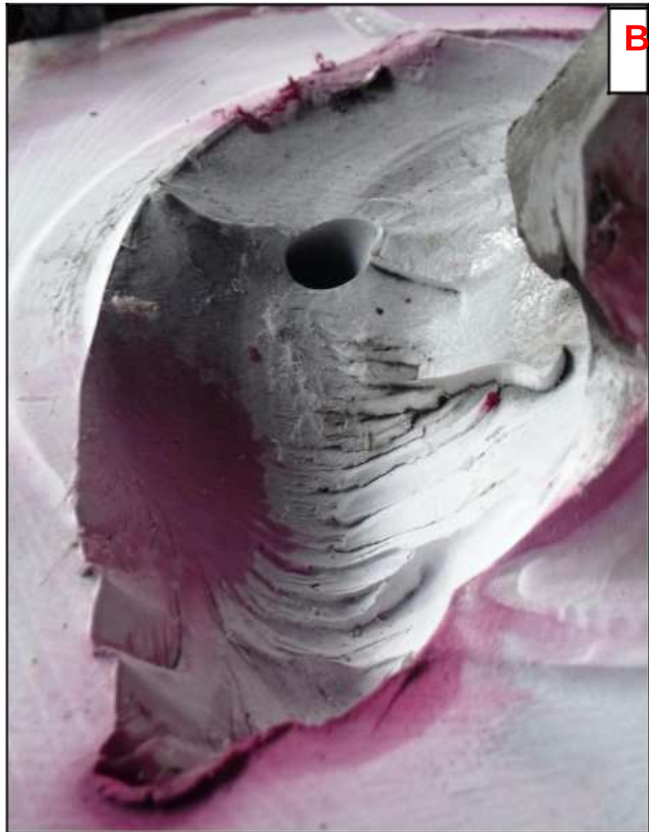
FIGURA 2.24 MUESTRA DE MORFOLOGÍA DE LA FALLA POR FATIGA (MARCAS DE PLAYA)
