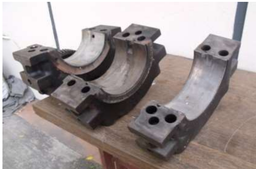
FIGURA 2.8 CEPÓS E BANCADA DEFORMADOS
