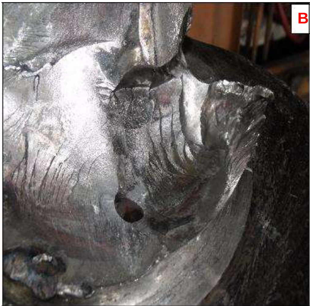
FIGURA 2.25 ORIGEN DE LA RUPTURA DEL CIGÜEÑAL
