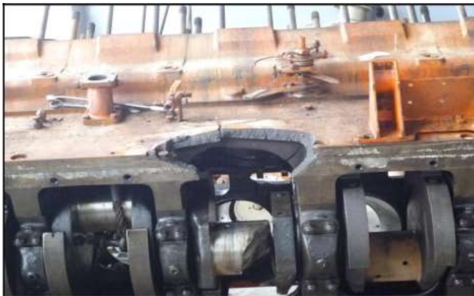
FIGURA 2.1 FRACTURA EXTERNA DEL BLOCK
