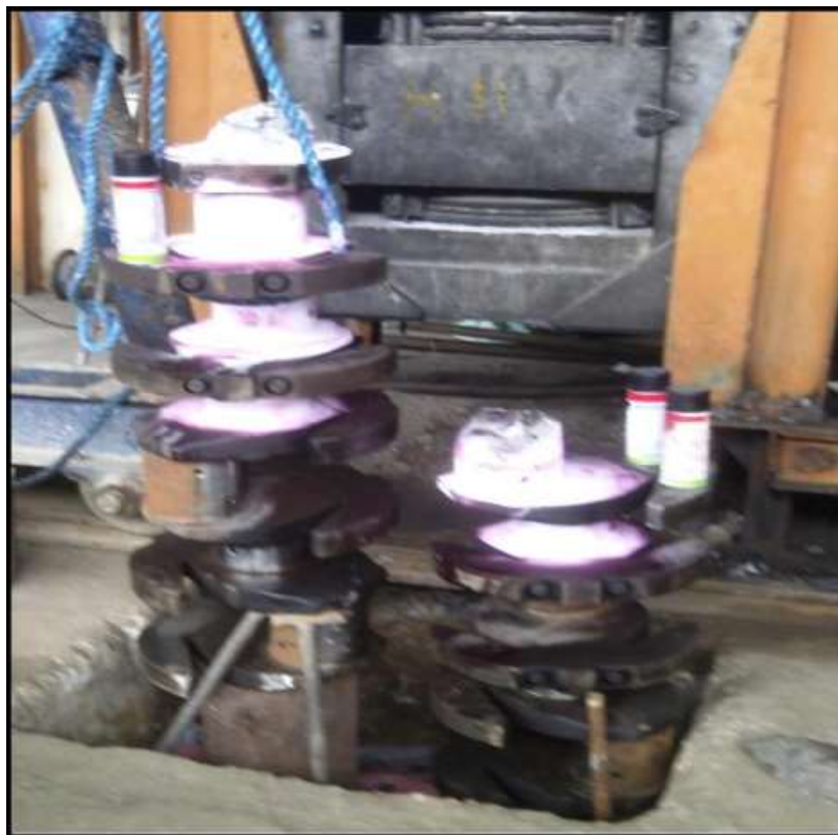
FIGURA 2.20 CIGÜEÑAL EN POSICIÓN VERTICAL ENSAYADO CON TINTAS PENETRANTES
