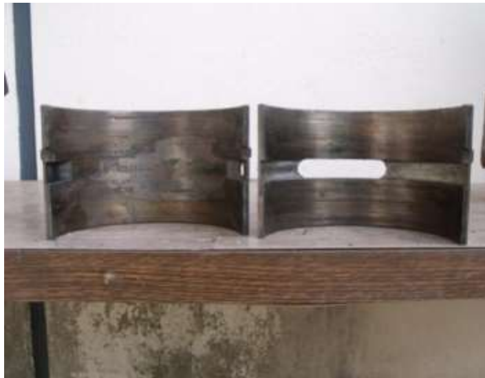
FIGURA 2.7 CHAPAS DE BIELA SIN MATERIAL NFITRION
