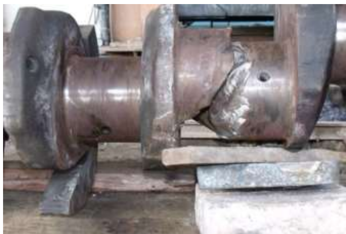
FIGURA 2.6 MUÑÓN DE BIELA FRACTURADO
