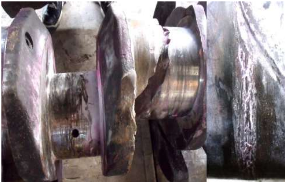
FIGURA 2.19 RAYADURA Y ADHERENCIA DE METAL BABBIT EN LA POSICIÓN 7 Y 8 EN EL CIGÜEÑAL.
