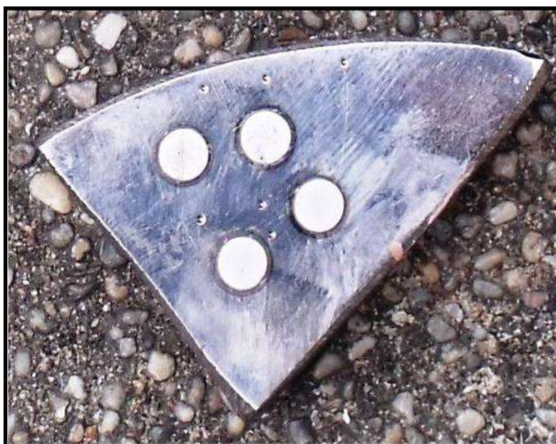
FIGURA 2.12 PROBETA DEL METAL DEL CIGÜEÑAL EN QUE SE ANALIZÓ LA COMPOSICIÓN QUÍMICA.
