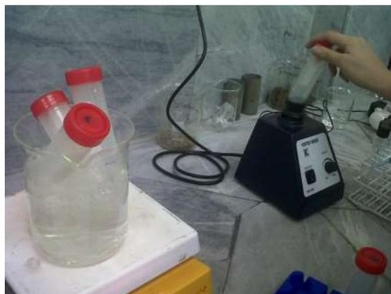
11. Remover los tubos del baño de agua hirviendo e inmediatamente añadir 4 mL del Solvente Con A. Mezclar en el VORTEX MIXER a alta velocidad.
