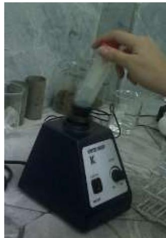
Añadir otros 4 mL de etanol al 95%, tapar el tubo e invertir para mezclar.
