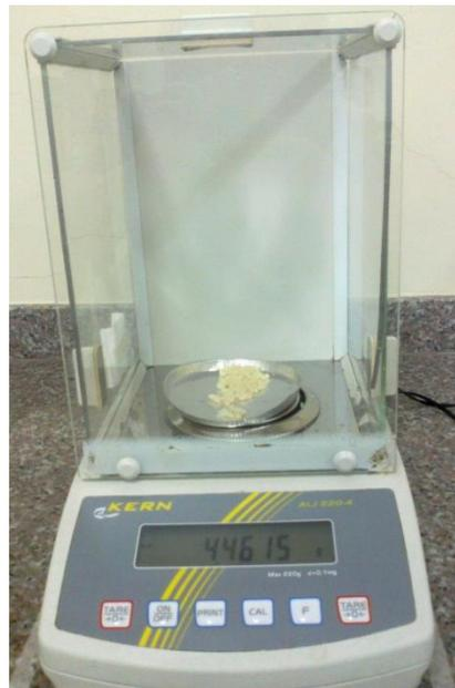
Balanza Analítica con muestra de pan
