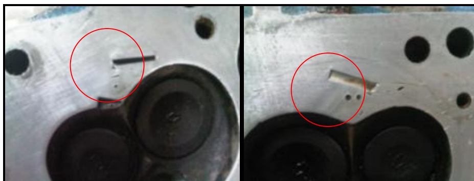
FIGURA 2.1 MARCAS ENCONTRADAS EN EL CABEZOTE DEL MOTOR EN LOS CILINDROS 3 Y 4 RESPECTIVAMENTE
