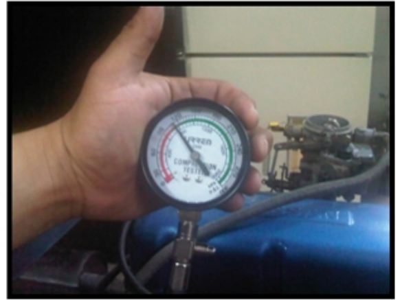
Presión de compresión del cilindro N°2
