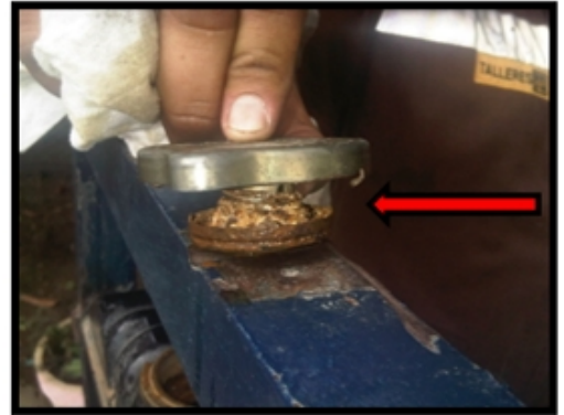
Tapa del radiador fuera de servicio
