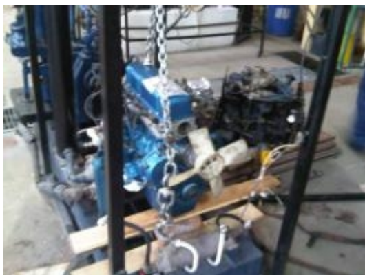
Instalación de motor Nissan A12 al dinamómetro
