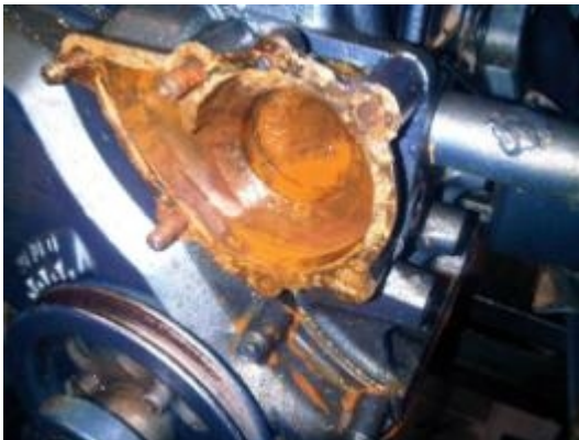
Presencia de sedimento en sistema de refrigeración de motor
