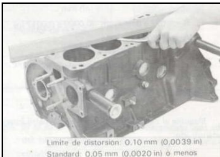
FIGURA 2.12 COMPROBACIÓN DE LA SUPERFICIE DEL BLOQUE DE CILINDROS
