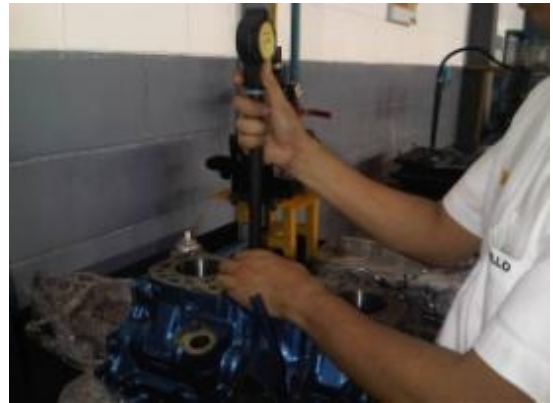
Midiendo con el comparador de diámetros internos
