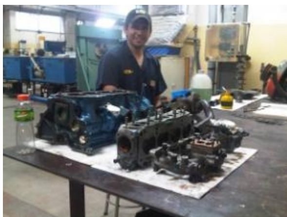
Motor totalmente desarmado y limpio para su posterior diagnostico
