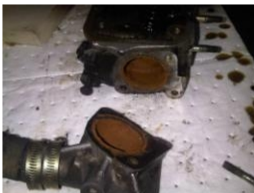
Sedimentos dentro de los conductos de refrigeración del cabezote
