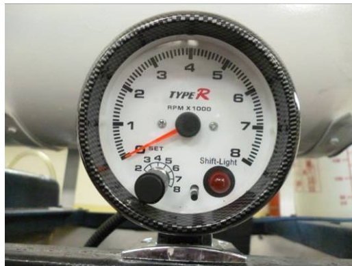
Medidor eléctrico de RPM del motor nuevo
