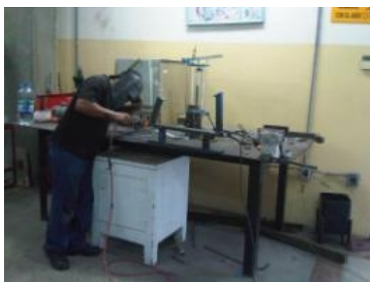
Modificando las bases del motor anterior para poder trabajar con el motor Nissan A12
