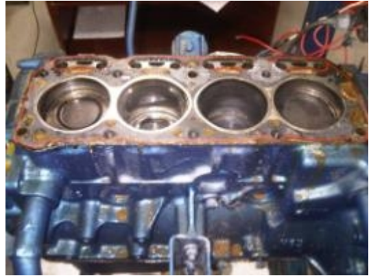
Presencia de sedimento en parte superior del bloque
