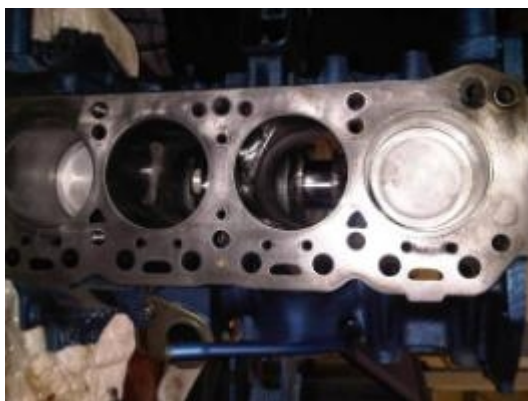
Instalación de los pistones nuevos
