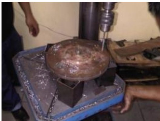
Adaptación de la conexión del dinamómetro para trabajar con el Nissan A12
