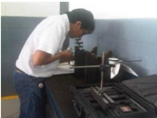
Midiendo los moñones de biela y bancada con el micrómetro de diámetros externos
