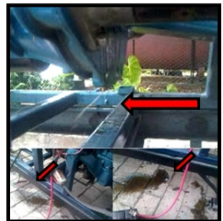
Fuga de aceite por el retenedor de aceite del cigueñal
