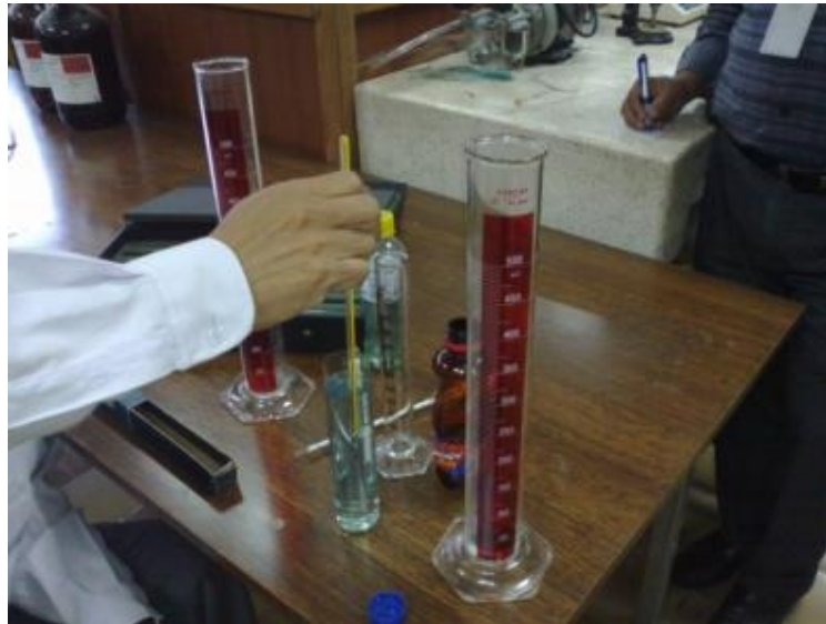
Equipos utilizados para determinar la densidad de los combustibles utilizados en las pruebas dinamométricas
