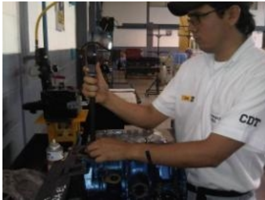
Medición del desgaste de las camisas del bloque del motor
