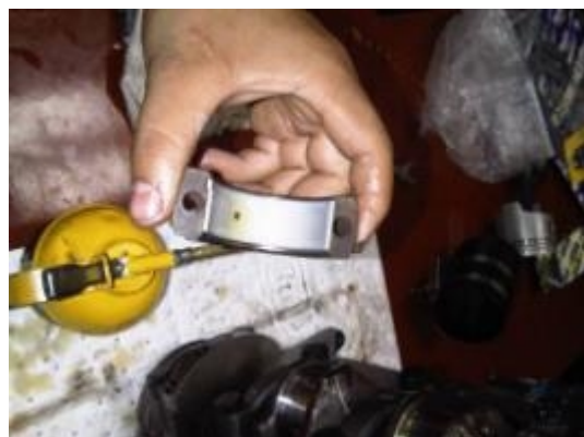
Instalación de cojinetes de biela y bancadas nuevos
