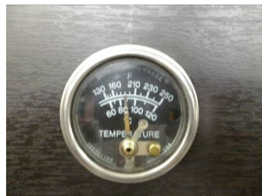
Medidor mecánico de la temperatura del motor nuevo
