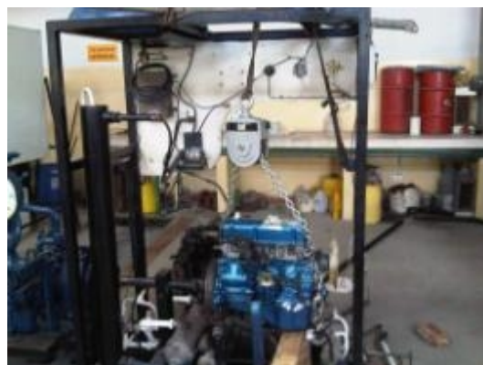
Presentando el motor Nissan A12 en las bases del motor anterior
