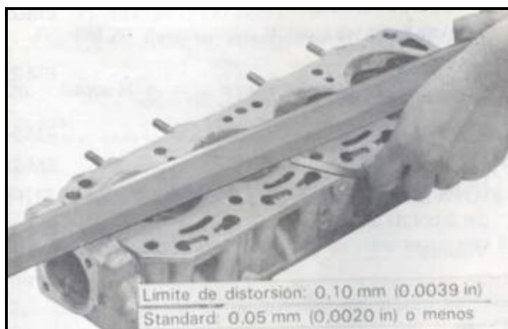
FIGURA 2.2 COMPROBACIÓN DE LA SUPERFICIE DEL CABEZOTE
