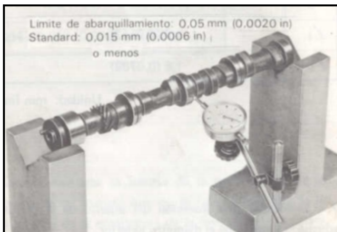
FIGURA 2.10 COMPROBACIÓN DE LA DEFLEXIÓN DEL ÁRBOL DE LEVAS
