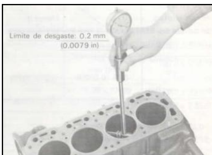
FIGURA 2.13 MEDICIÓN DEL CALIBRE DEL CILINDRO
