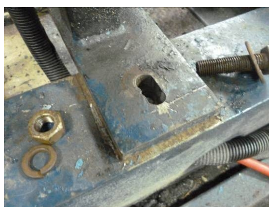
Maquinado de ranura para realizar una correcta alineación del motor con el dinamómetro
