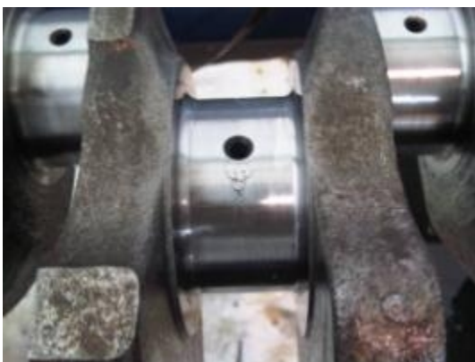
Moñón de biela y bancada ligeramente pulidos para desprender marcas de agua
