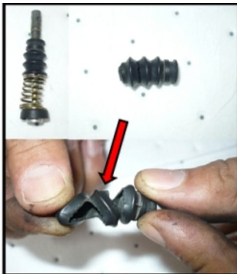
Guardapolvo del pistón del carburador roto
