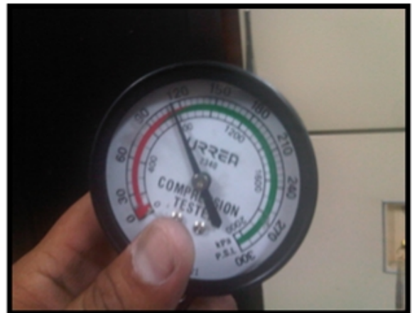
Presión de compresión del cilindro N°4
