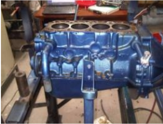
Motor en cuerpo de bombeo con cabezote desmontado
