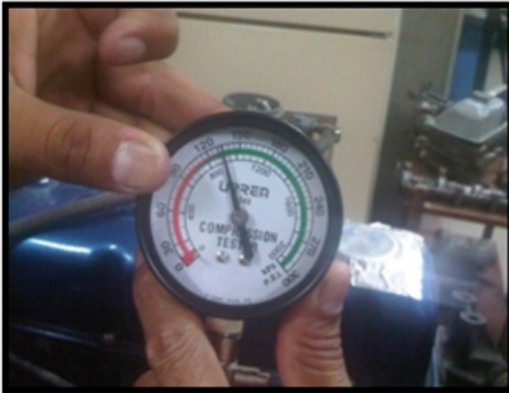
Presión de compresión del cilindro N°1
