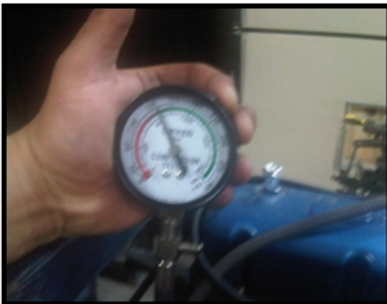
Presión de compresión del cilindro N°3
