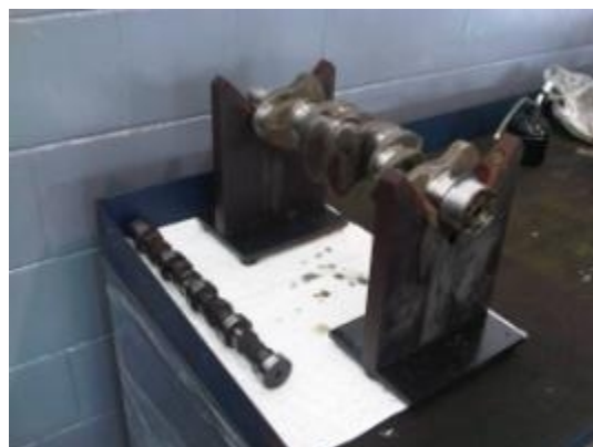
Barra de levas y cigüeñal evaluados limpios y lubricados para su posterior instalación
