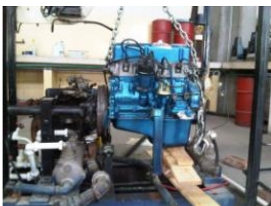
Motor Nissan A12 sujeto sin bases de motor anterior
