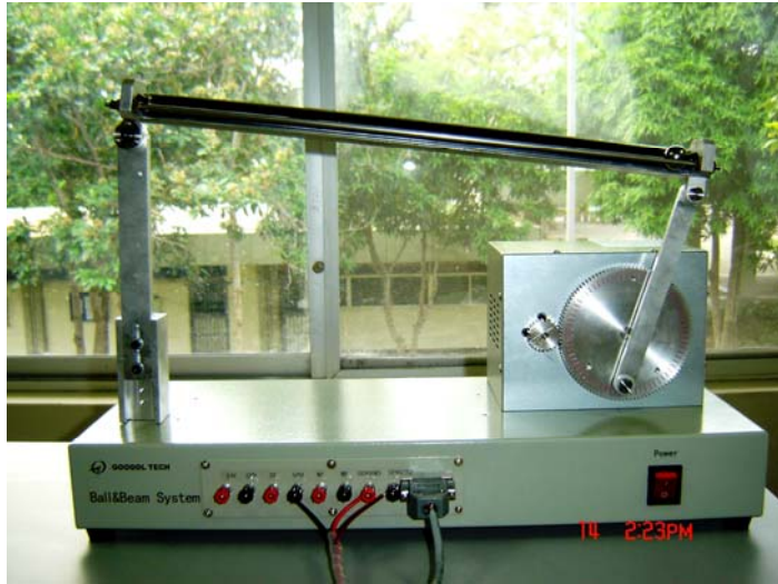
FIGURA 1.2.1. EQUIPO IMPLEMENTADO DEL SISTEMA BOLA Y VIGA
