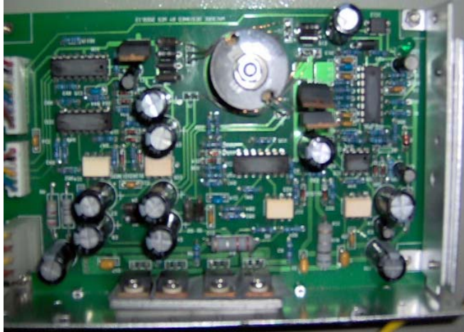
FIGURA 1.3.4.1. DRIVE DEL MOTOR
