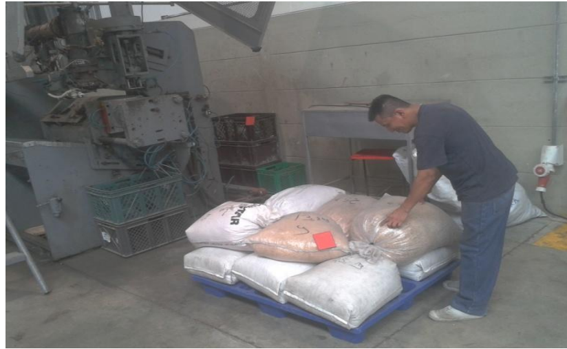
FIGURA 4.2 TARJETAS ROJAS EN ELEMENTOS QUE TIENEN QUE SER REUBICADOS
