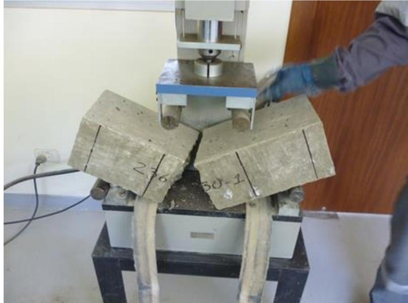
**Fotografía 7.12** Rotura de los agregados y no desprendimiento
