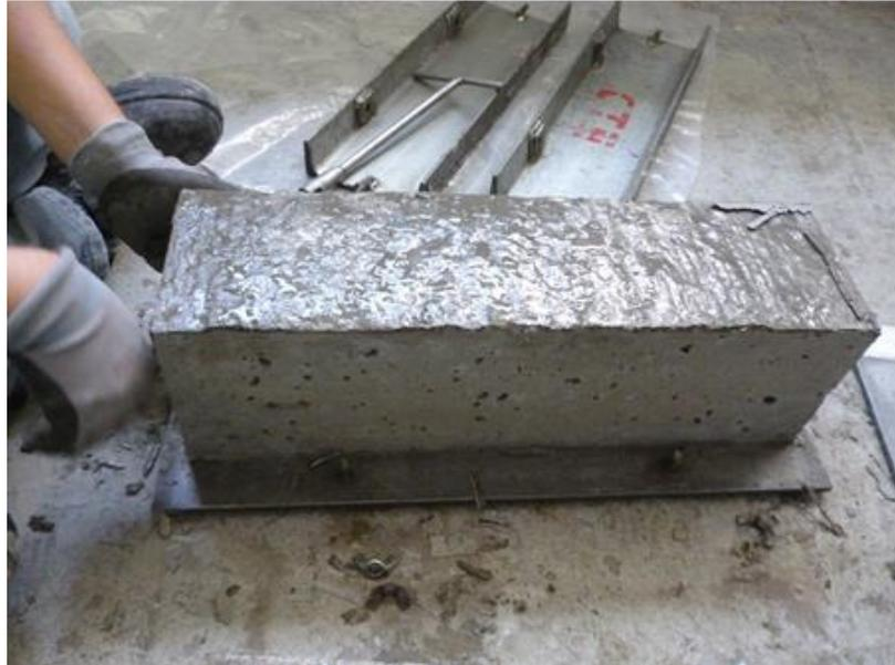
**Fotografía 7.10 Rotura de Vigas**
