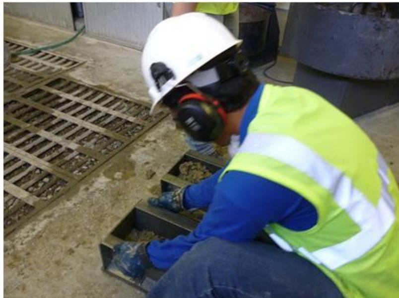
**Fotografía 7.7** Moldeo de vigas en 2 capas
