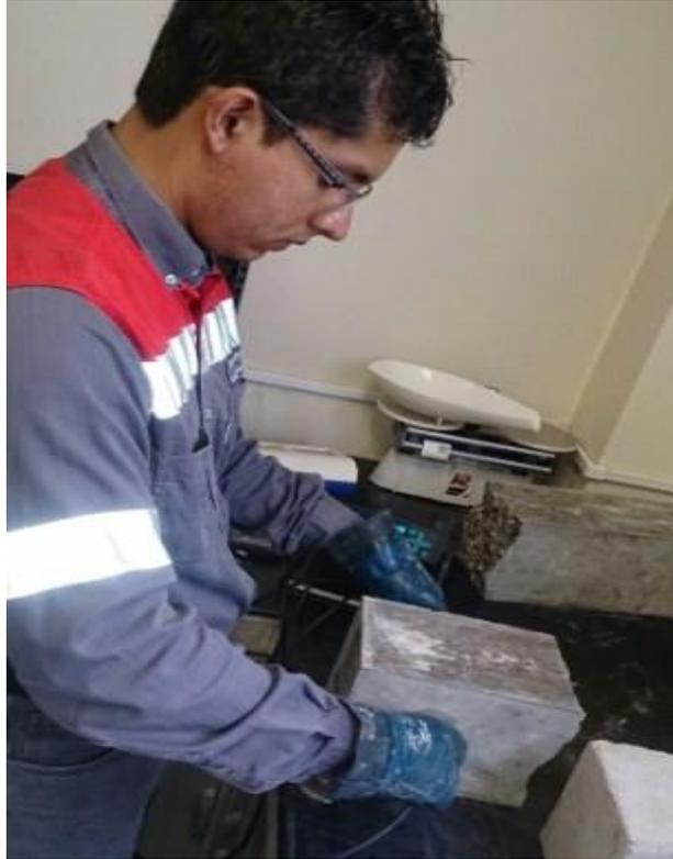
**Fotografía 7.14** Ensayo de permeabilidad al Aire
