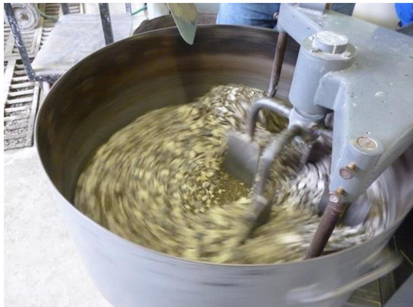
**Fotografía 7.5** Mezclado de agregados con agua por varios minutos
