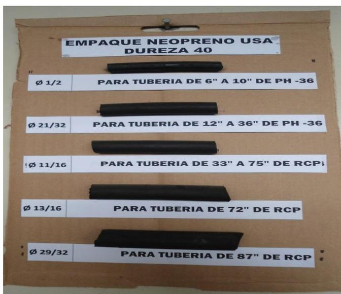
Figura 1.6 Tabla de empaque de neopreno usa dureza 40
