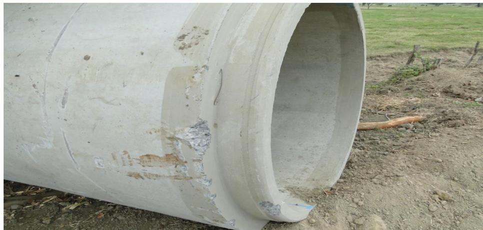
Figura 5.2 Tramo de alcantarilla desechada por sus averías
