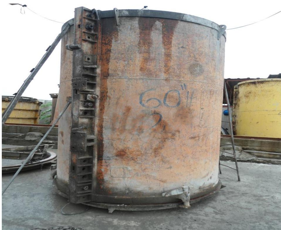
Figura 1.4 Molde para tubo de 60 pulgadas
