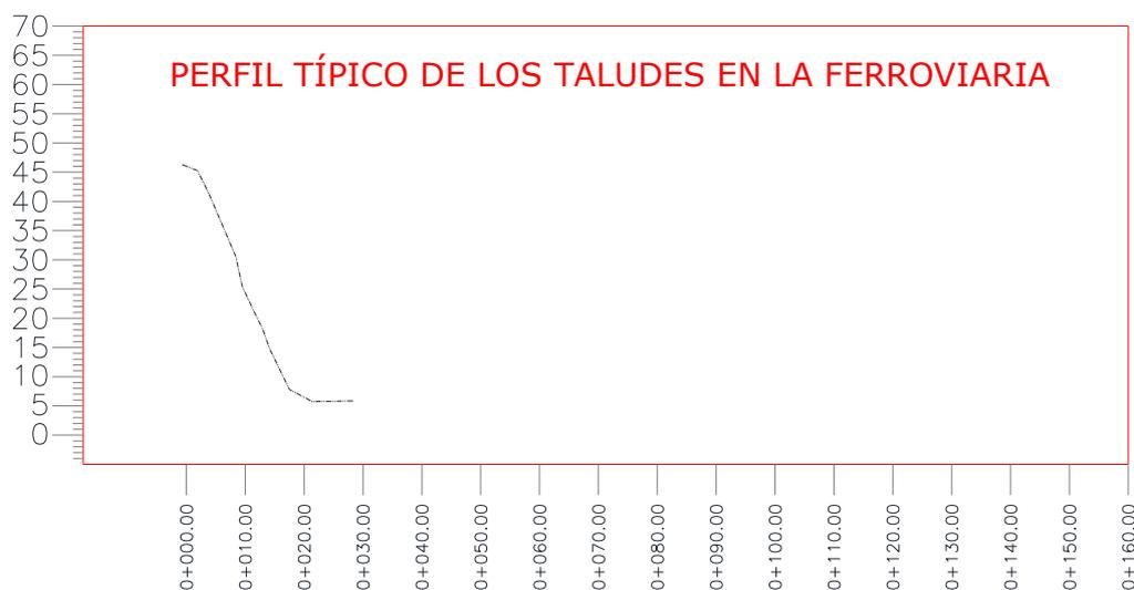
Figura 2.14 Perfil longitudinal de talud en la Ferroviaria.
