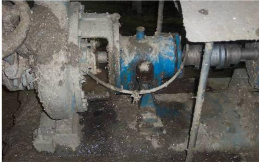
**Figura N° 1.11:** Bomba limpiadores secundarios uniflow P06, molino 2.
