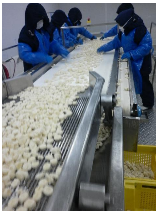
FIGURA 2.10. BANDA DE INSPECCIÓN.
