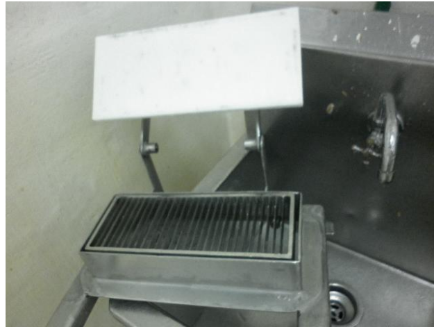
FIGURA 2.8. CUCHILLAS DE CORTE RODAJAS 8-10 MM UTILIZADAS EN PLANTA
