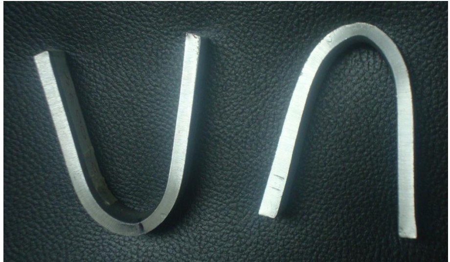
Figura 2. 32.- Especímenes para los ensayos de doblado de cara y de raíz
