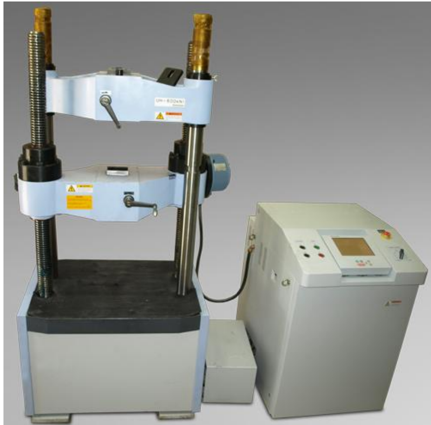
Figura 2. 27.- Máquina Universal de Ensayos (UTM-600KN)
