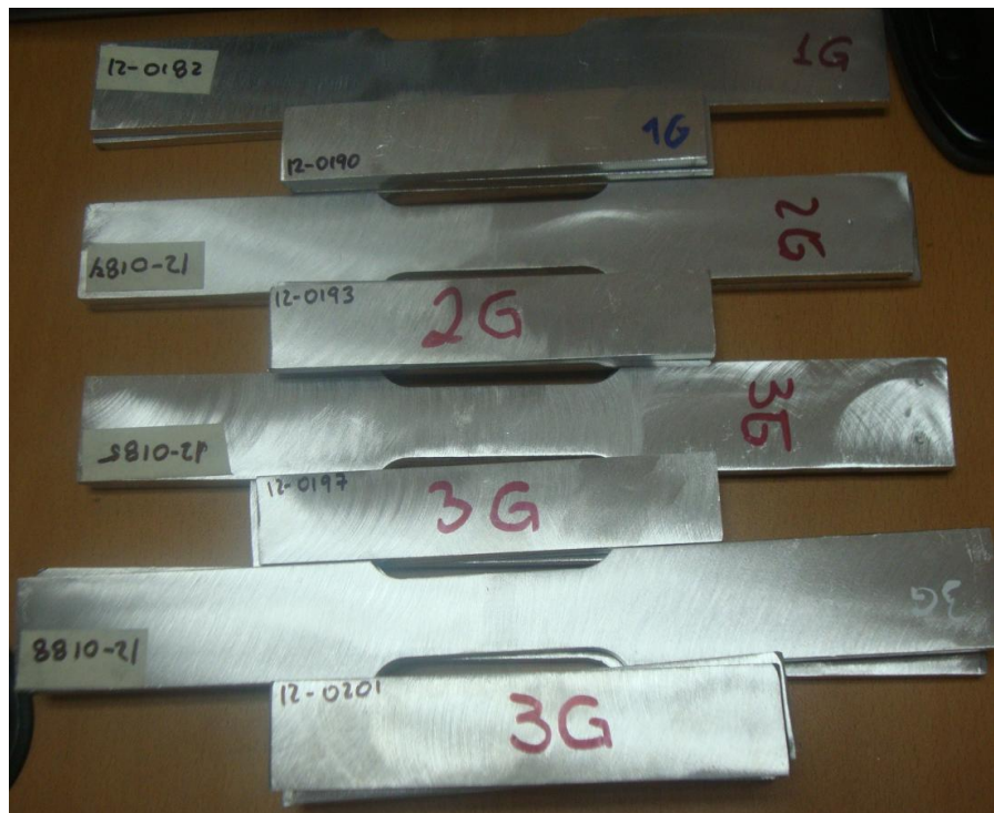
Figura 2. 26.- Especímenes para ensayos de tracción y doblado
