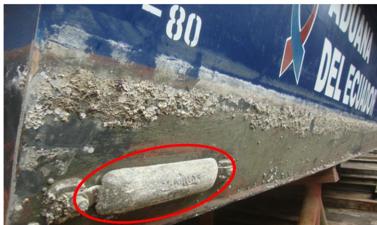
Figura 1. 2.- Ánodo de sacrificio en una embarcación
