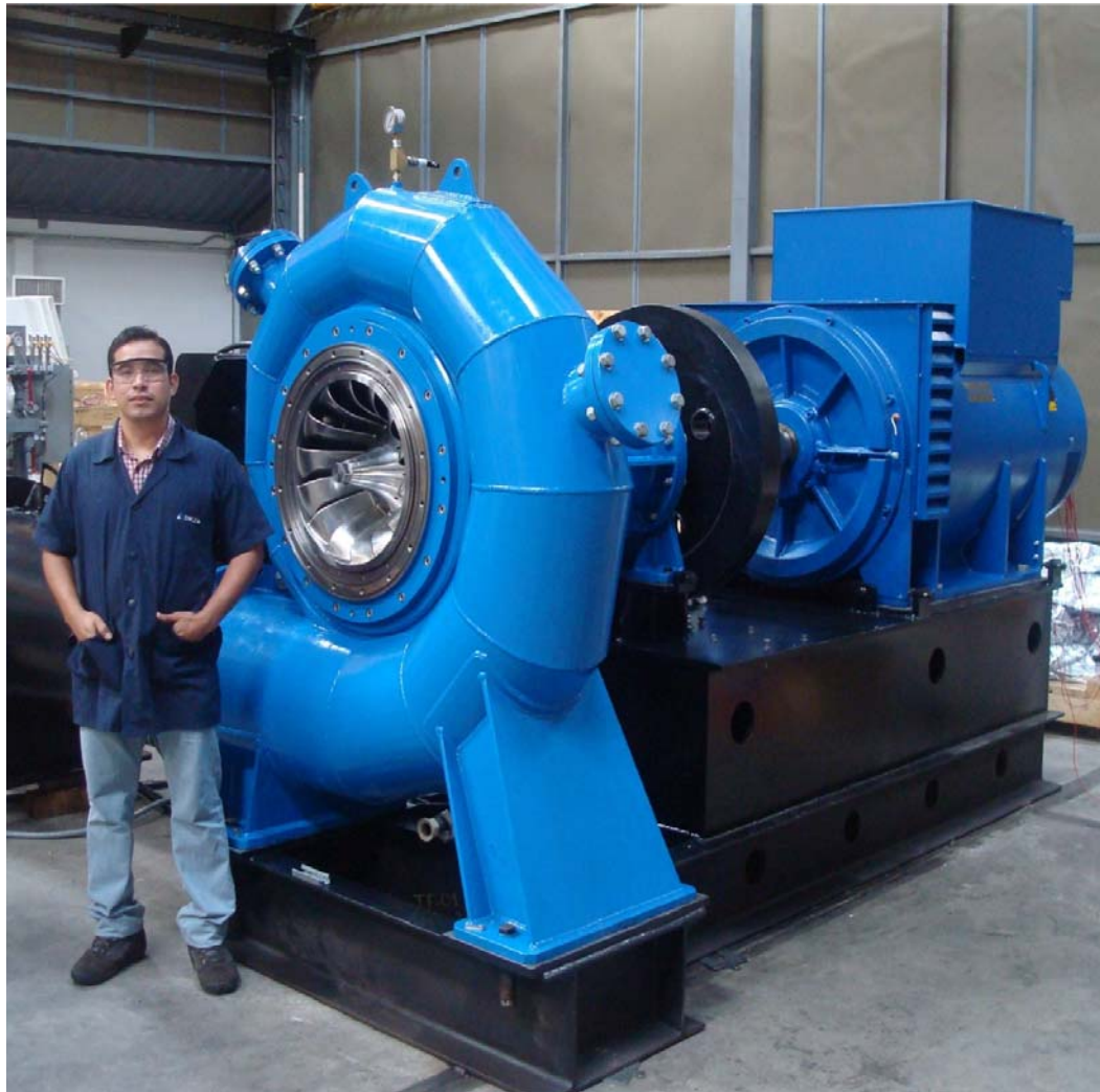
FIGURA 2.16 TURBINA FRANCIS PROYECTO HIDROMIRA, 1MW.
