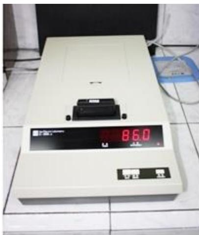
**FIGURA 3.1 MEDIDOR DIGITAL DE BLANCURA DE ARROZ
