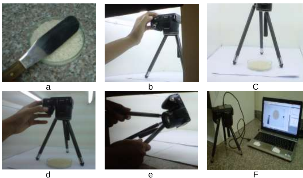
Figura 2.2. Procesamiento para toma, acondicionamiento y análisis de la muestra: a) Acondicionamiento de muestra, b) Pre-ajuste, c) Colocar muestra, d) Captura, e) Retirar cámara, f) Transferir imagen
