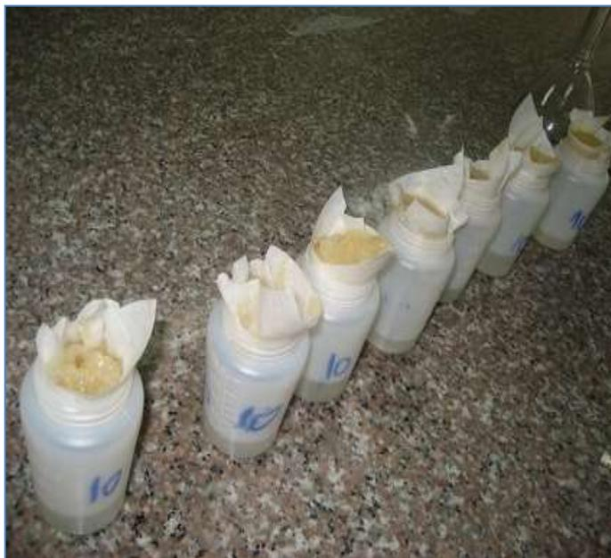
**FIGURA 1.11.- ELIMINACIÓN DE ÁCIDOS CON ETANOL DE 60 GRADOS**
