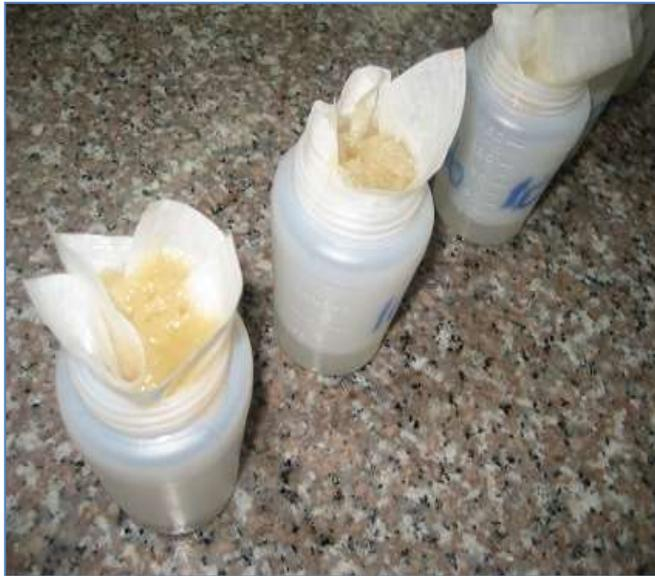
**FIGURA 1.10.- PRECIPITACIÓN DE LA PECTINA CON ETANOL DE 95 GRADOS**
