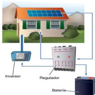
Fig.1 Sistema Fotovoltaico Con Acumuladores (Baterías). http://energia.fi-b.unam.mx:8090/proyecto16/proyecto.pdf
